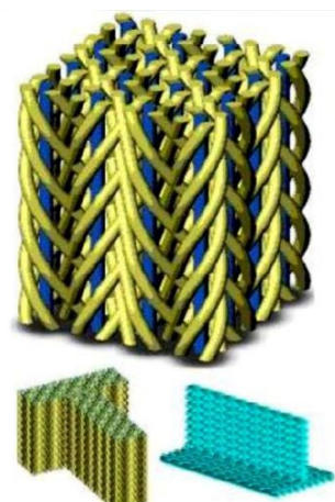
Рисунок 2 – Структура, получаемая 3D-плетением
