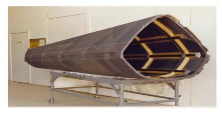
Рисунок 2 — Фотография подкрепленного хвостового конуса вертолета Sikorsky S-75
