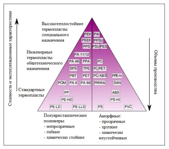
Рисунок 5 — Перечни и обобщенные характеристики основных термопластичных полимеров, используемых в качестве матрицы армированных ПКМ
