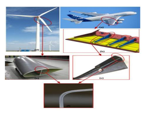
Рисунок 12 — Примеры макроскопического расслоения, армированного ПКМ в угловых элементах конструкций элерона крыла самолета и винта ротора ветроэнергоустановки
