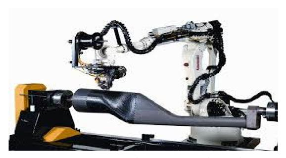
Рисунок 11 — Выкладочная головка фирмы «Automated Dynamics» США для производства композитных конструкций по аддитивной технологии
