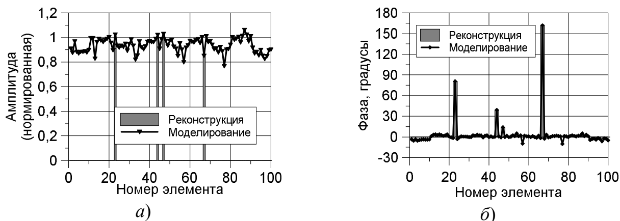
Рисунок 2.13 — Восстановленные по дополнительным измерениям а) амплитуда и б) фаза возбуждения дефектных элементов
