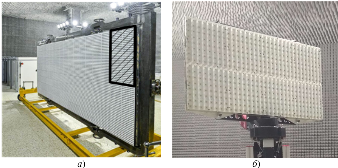
Рисунок 3.1 — Исследуемая решетка: а) решетка целиком, штриховкой выделен отдельный цифровой модуль; б) цифровой модуль на поворотном устройстве в безэховой камере
