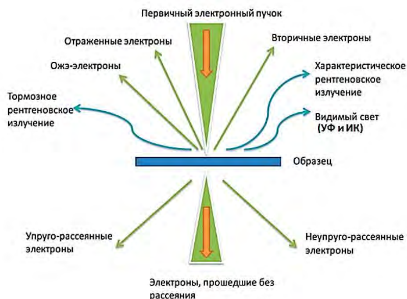
Рисунок 2.12 – Многообразие сигналов, возникающих в результате взаимодействия электронного пучка с поверхностью образца
