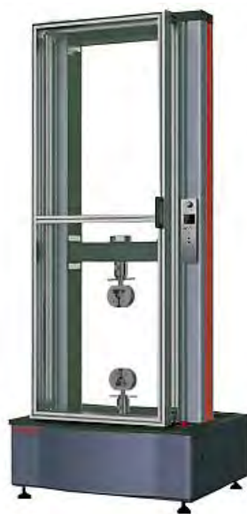
Рисунок 2.7. – Универсальная электромеханическая испытательная машина DC M-DS (1000 кН)
