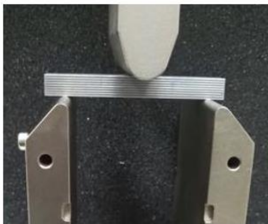
Рисунок 2.9. – Испытательный образец перед испытанием на изгиб по методу короткой балки
