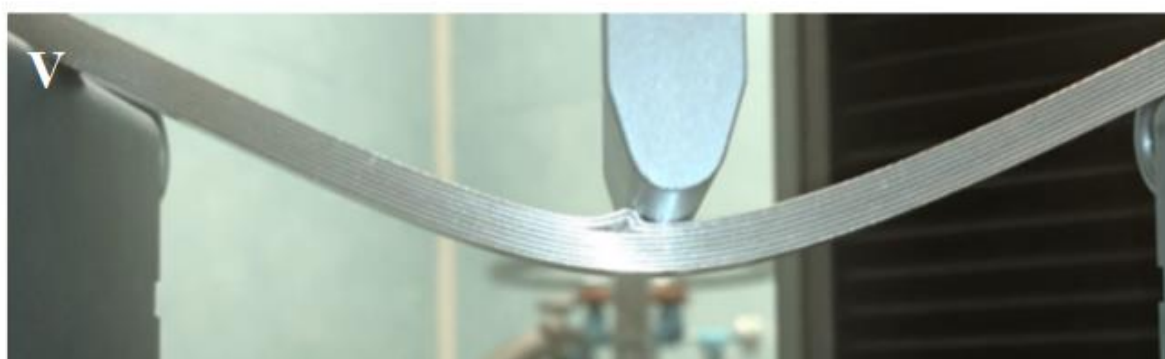
Рисунок 2.34 – Механизм разрушения алюмопластика 9/8 для диапазона удлинений образцов V.
