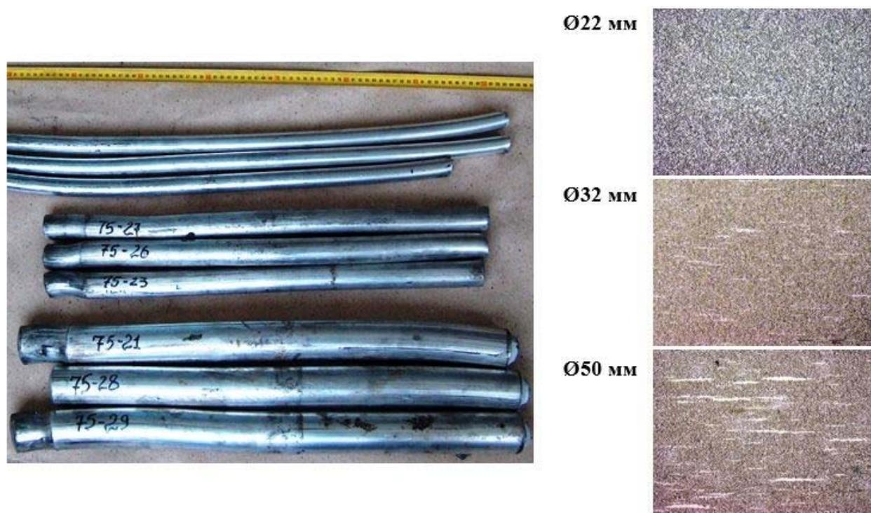
Рисунок 5 – Прессованные прутки САС-1-50 диаметрами 22, 32 и 50 мм (слева) и их микроструктура (справа).
