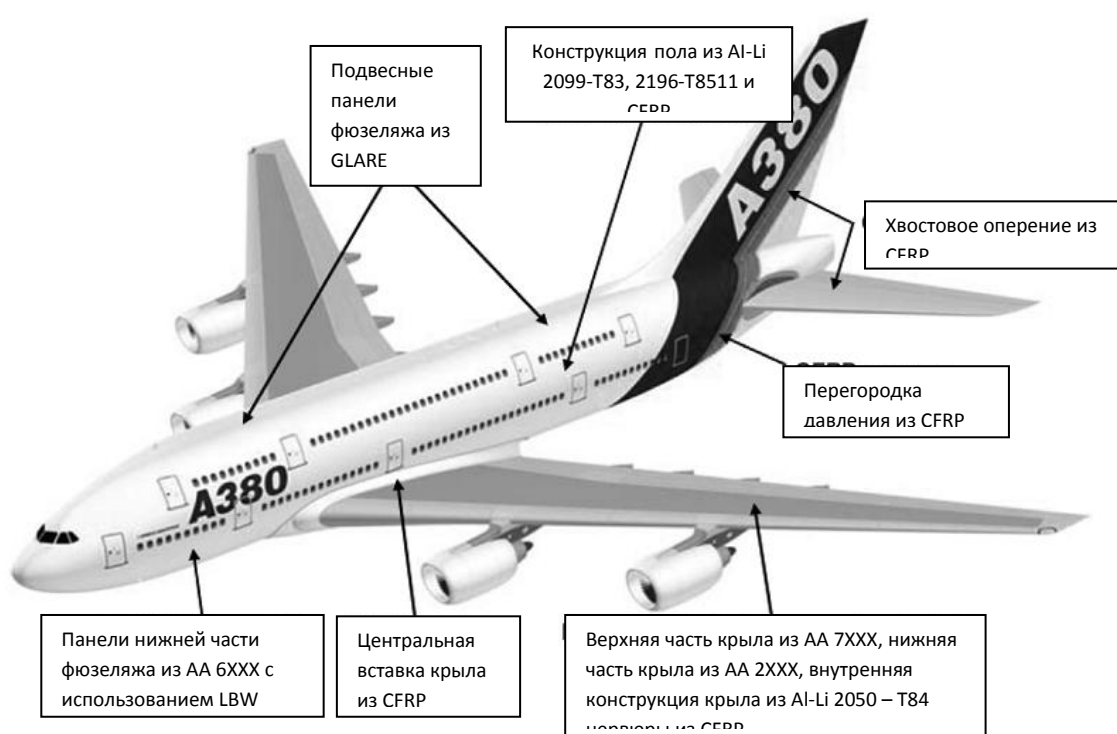
Рисунок 1.5 Современные материалы и технологии в основных зонах конструкции Airbus A380: LBW – сварка лазерным лучом; CFRP – углепластик; GLAR – слоистый алюмокомпозит (СИАЛ) [4]
