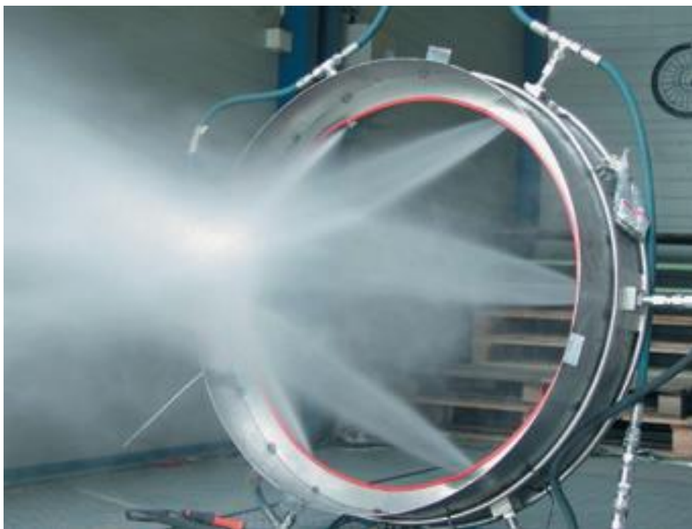
Рисунок 1.12 - Устройство для промывки проточной части ГТУ производства компании GTE [51]
