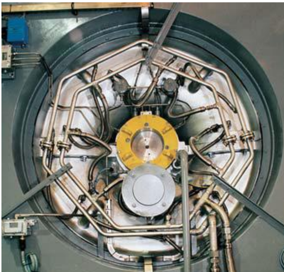
Рисунок 1.13 - Система промывки проточной части ГТУ производства компании General Electric [55]
