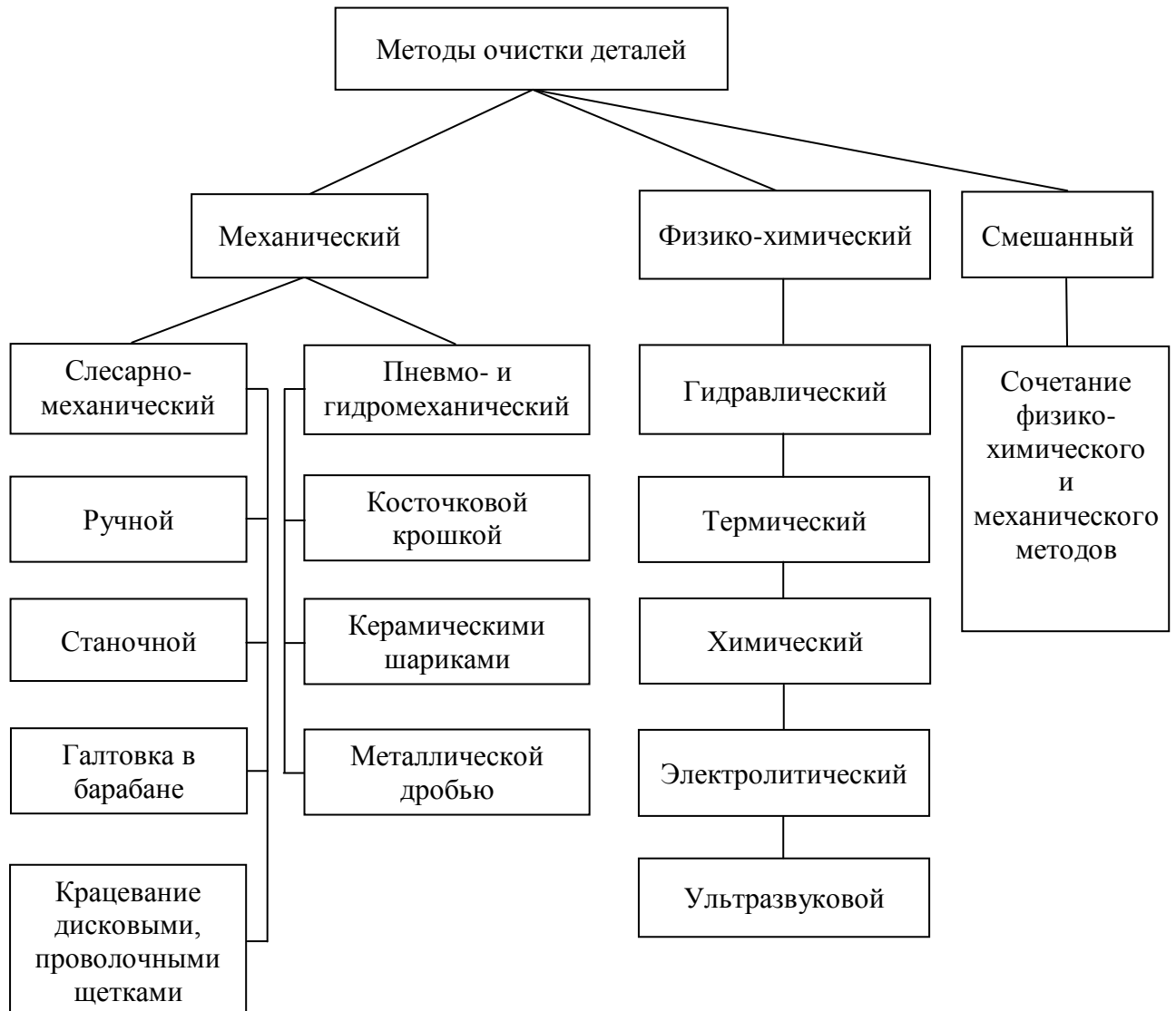
Рисунок 1.14 - Основные методы очистки деталей от углеродсодержащих загрязнений [24]
