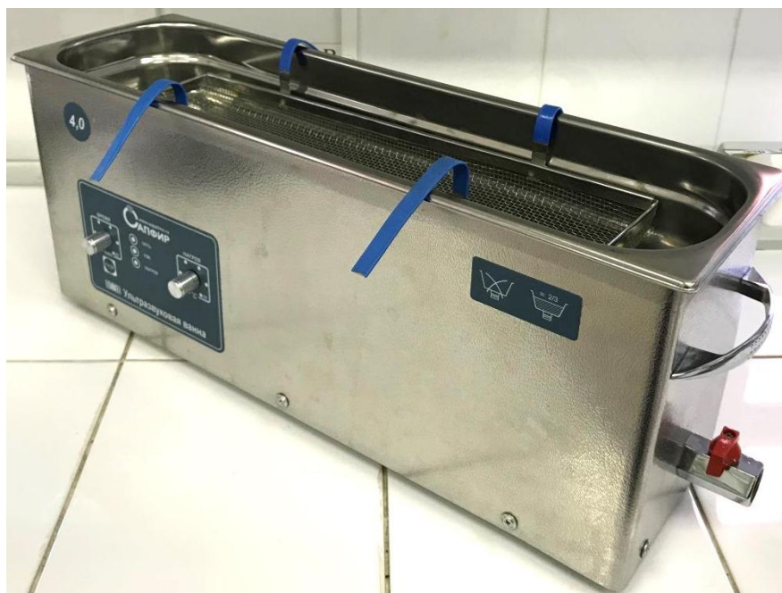
Рисунок 2.4 - Ультразвуковая установка «Сапфир»
