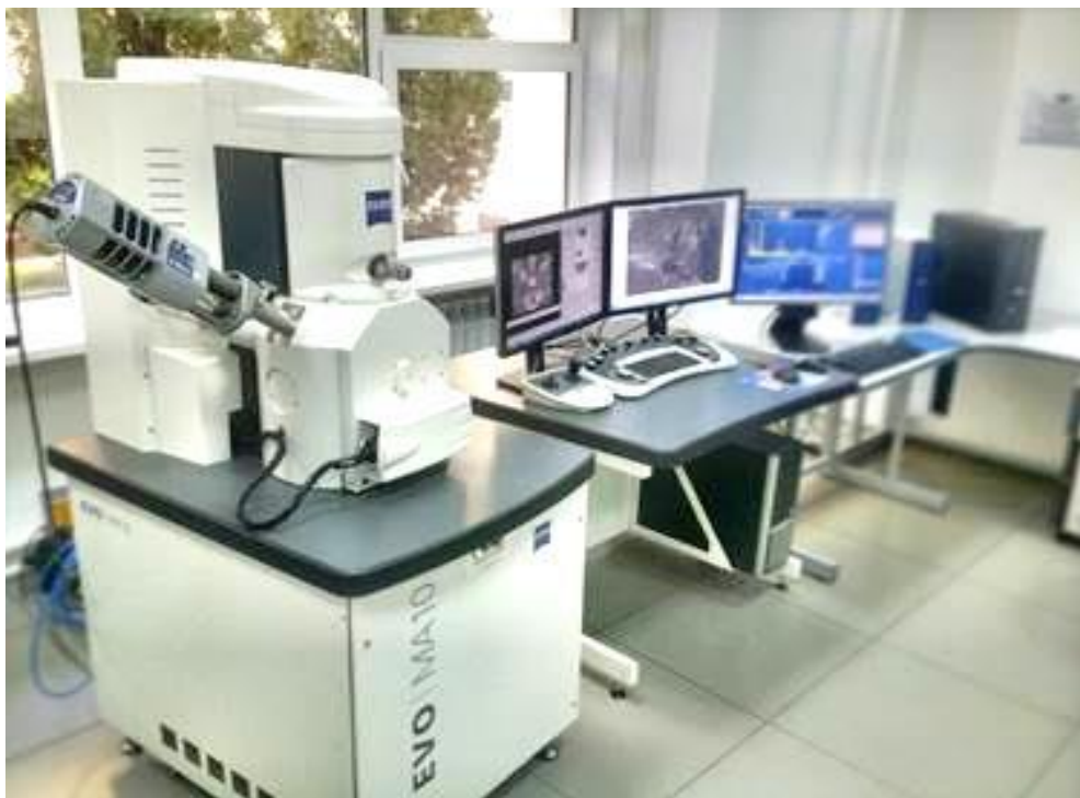
Рисунок 2.7 - Растровый электронный микроскоп Zeiss EVO MA 10
