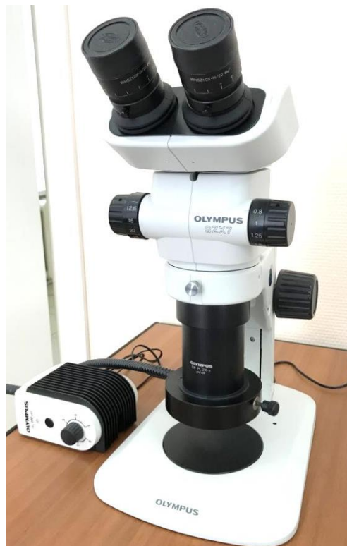
Рисунок 2.5 - Оптический микроскоп Olympus SXZ7
