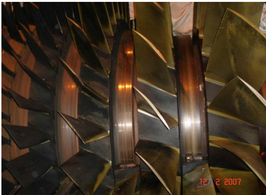
Рисунок 1.9 - Внешний вид загрязнений лопаток с первой по четвертую ступень компрессора ГТУ [19]
