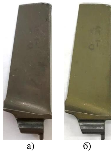
Рисунок 3.32 - Вид лопатки № 1: а) после эксплуатации; в) после удаления загрязнений
