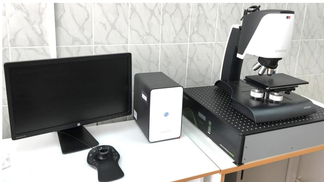
Рисунок 2.9 - 3D оптический профилометр Plu Neox Sensofar-Tech
