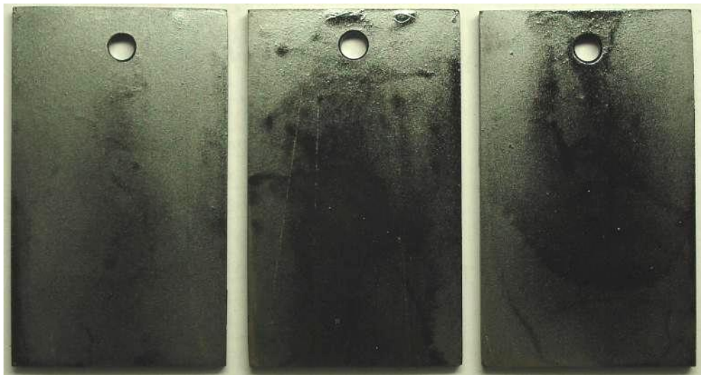
Рисунок 2.15 - Вид образцов титанового сплава VT20 после нанесения углеродсодержащих загрязнений, имитирующих эксплуатационные
