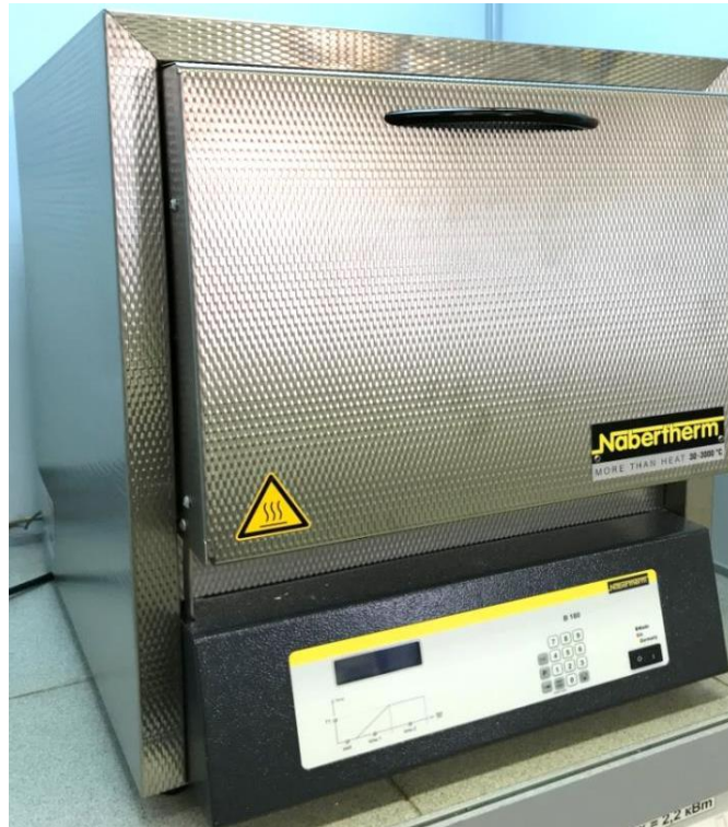
Рисунок 2.14 - Муфельная электропечь сопротивления Nabertherm
