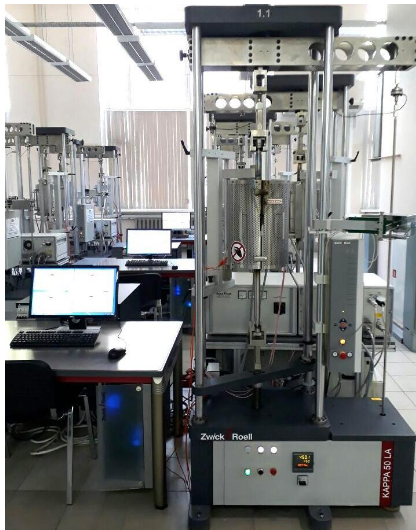
Рисунок 2.13 - Испытательная машина Zwick Карра 50 LA
