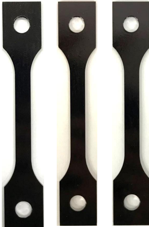
Рисунок 2.17 - Плоские образцы для проведения испытаний на растяжение после нанесения углерод содержащих загрязнений
