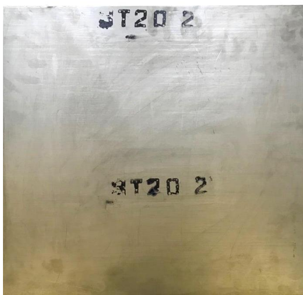
Рисунок 2.1 - Листовой полуфабрикат из жаропрочного титанового сплава BT20
