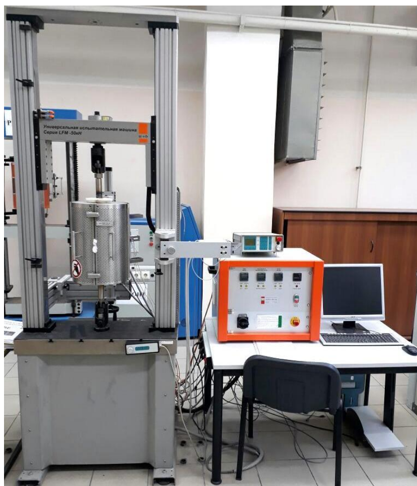
Рисунок 2.12 - Универсальная испытательная машина Walter+Bai LFM-50
