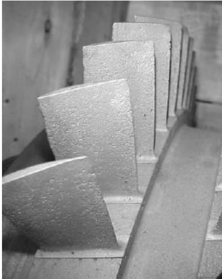
Рисунок 1.3 - Коррозионные повреждения на поверхности лопаток компрессора, изготовленных из нержавеющей стали [9]
