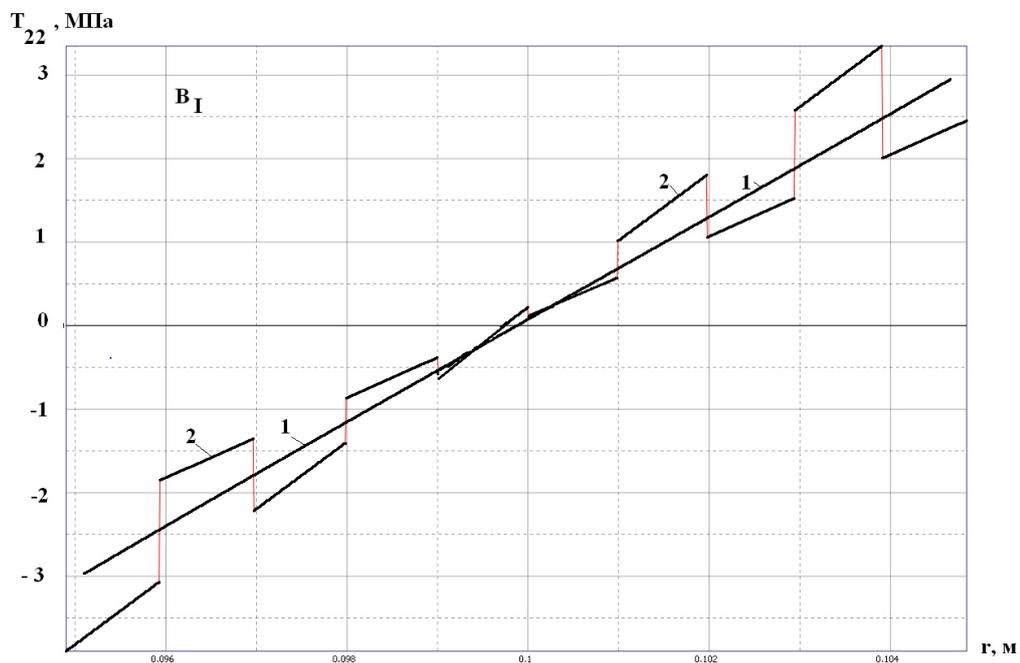
Рисунок 4.10 – Распределение по радиусу  $r$  компоненты  $T_{22}$  среднего тензора напряжений Коши (кривая – 1), вычисленной по формуле (4.52), и компоненты  $T_{22}^{(0)}$  тензора напряжений в слоях композитной панели при цилиндрическом
