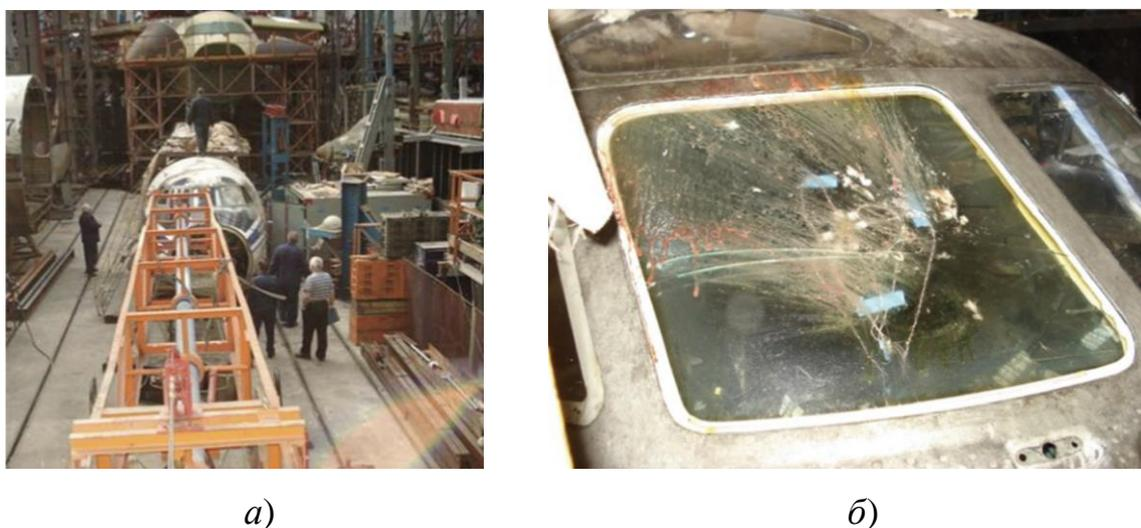
Рисунок 1.11 – Пневматическая пушка (а) и ламинированное лобовое стекло после испытаний (б)
