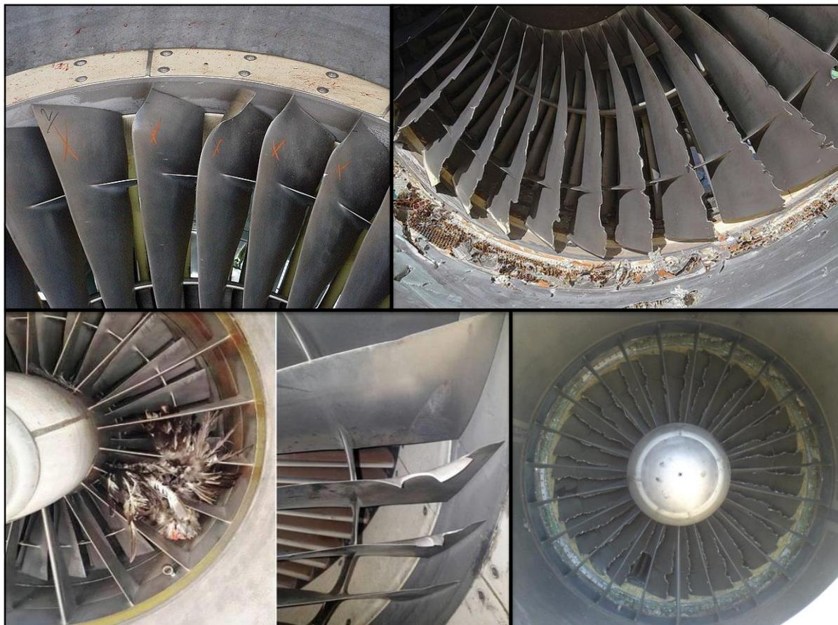
Рисунок 1.4 – Повреждения на входе ГТД, вызванные попаданием птиц
