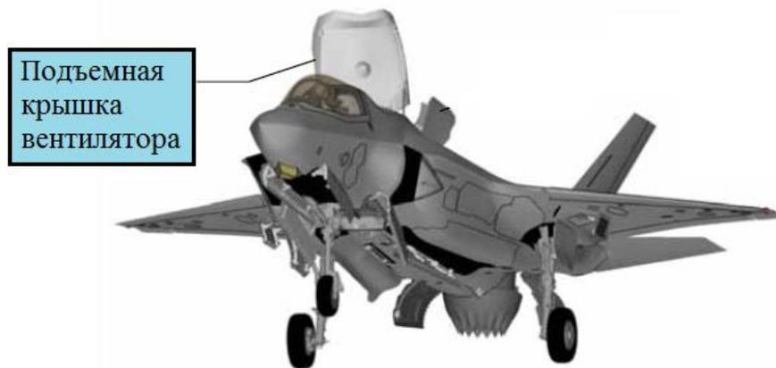
Рисунок 1.20 – Крышка вентилятора F-35B
