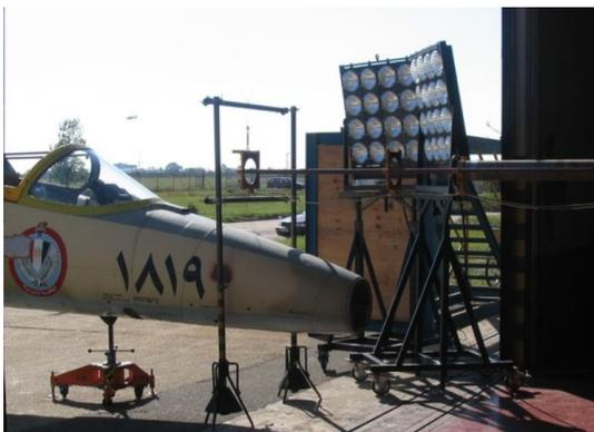
Рисунок 1.14 – Остекление кабины перед испытанием
