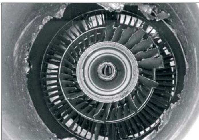
Рисунок 1.6 – Повреждения лопаток вентилятора и газоздушного тракта силовой установки при попадании птицы
