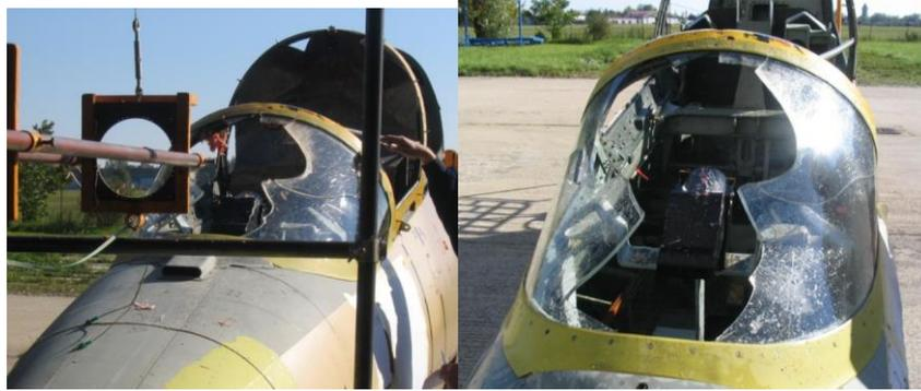
Рисунок 1.16 – Пробитие лобового стекла при ударе
