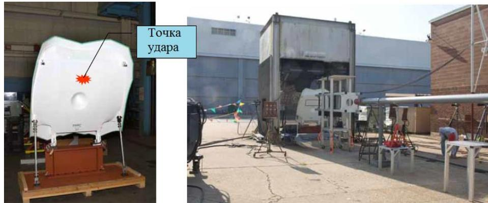
Рисунок 1.21 – Точка удара птицы и общий вид стенда
