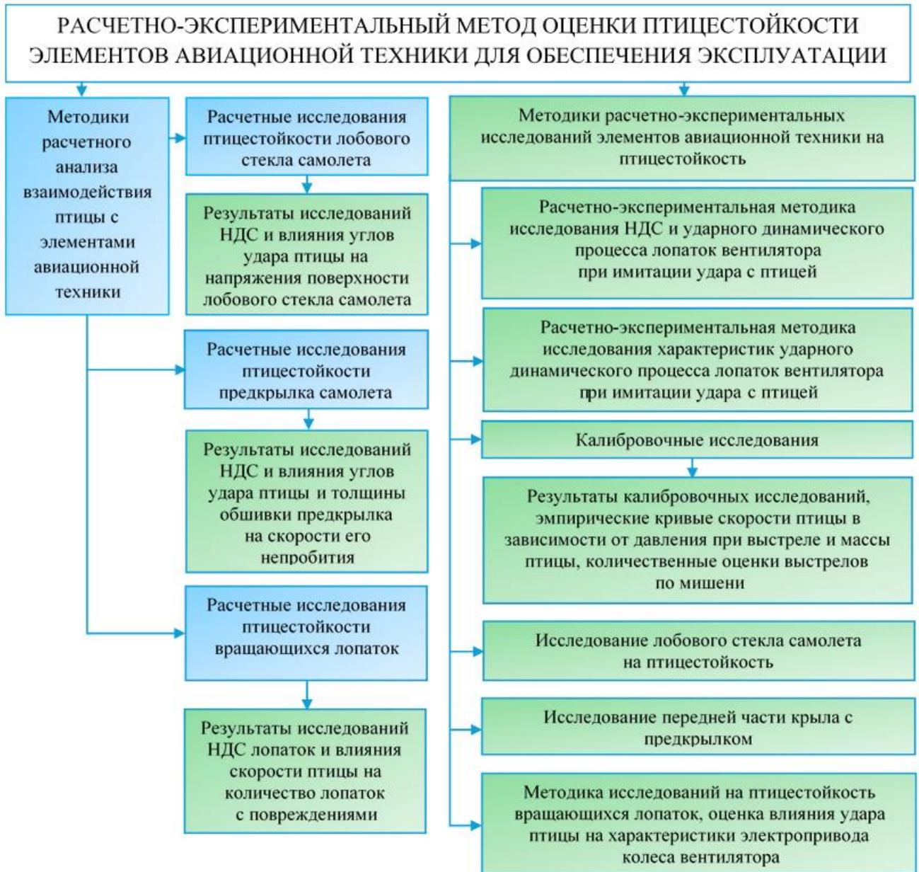
Рисунок 1.1 – Блок-схема расчетно-экспериментального метода оценки птицестойкости элементов авиационной техники для обеспечения эксплуатации летательных аппаратов
