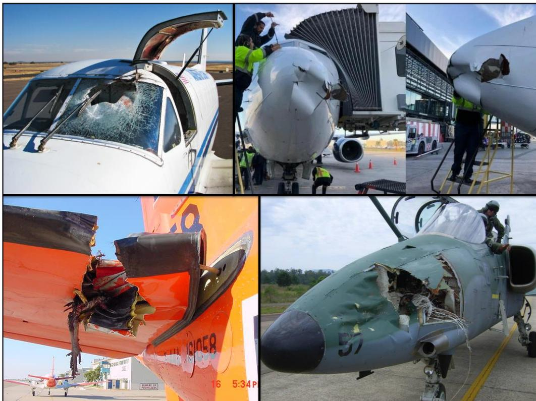
Рисунок 1.5 – Последствия столкновений с птицами для авиационной техники
