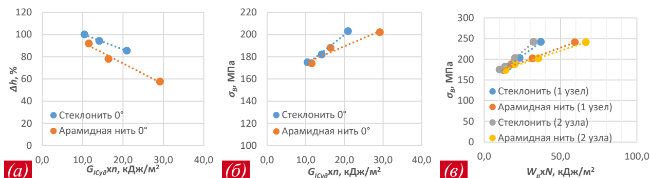
Рис. 9 – Примеры корреляционных зависимостей между параметрами поврежденности \Delta h (а) и остаточной прочности при сжатии \sigma_{\text{в}} (б, в) после внеплоскостного удара с энергией 40 Дж и энергетическими параметрами межслоевой трещиностойкости и прочности ( G_{\text{ICyдхл}} , W_{\text{PхN}} соответственно)
