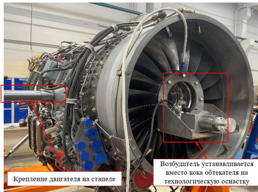
Рисунок 13 – Двигатель в сборе на тележке с технологической оснасткой
