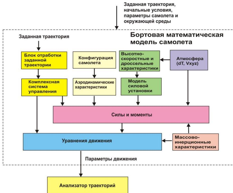
Рисунок 5.37 Структура бортовой математической модели самолета.
