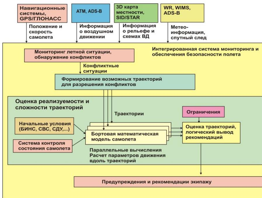
Рисунок 5.36 Система контроля летной ситуации и обеспечения траекторной безопасности полета.
