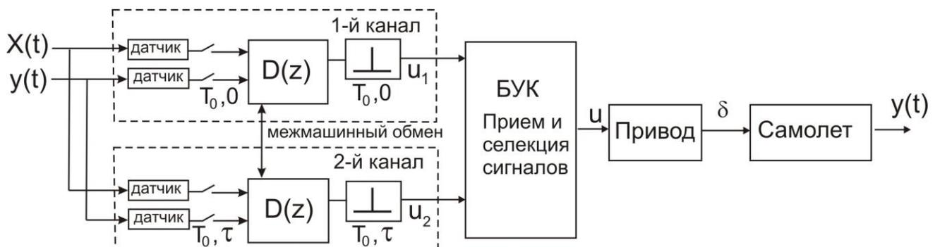
Рисунок 3.13 – Структура двухканальной цифровой асинхронной системы управления
