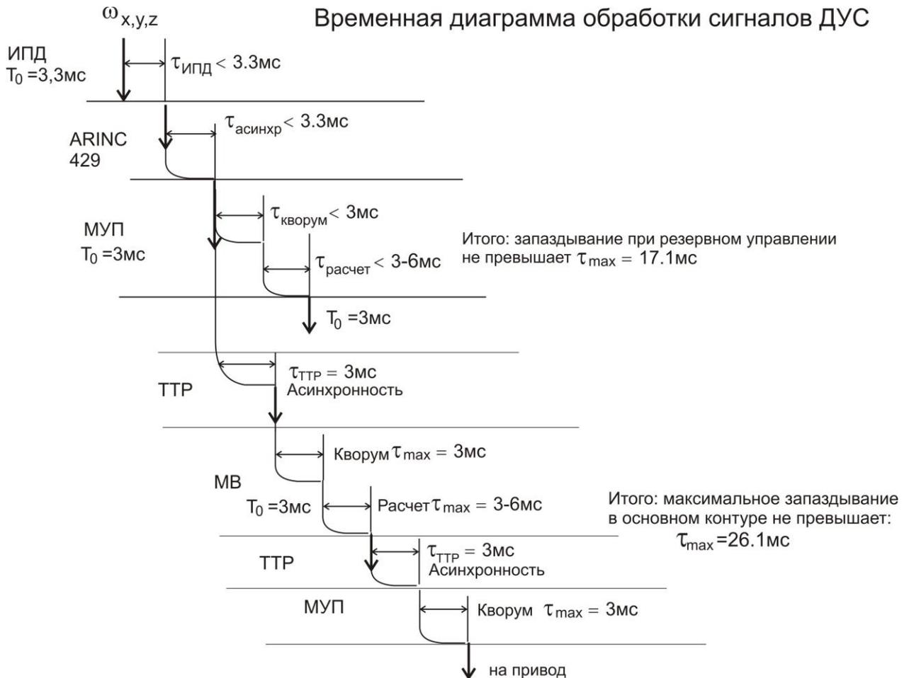
Рисунок 2.7 – Временная диаграмма прохождения сигналов угловых скоростей от ДУС до сигналов на управление приводами в МУП
