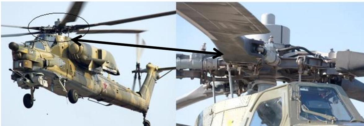
Рис. 1 Крепление лопасти к втулке несущего винта
