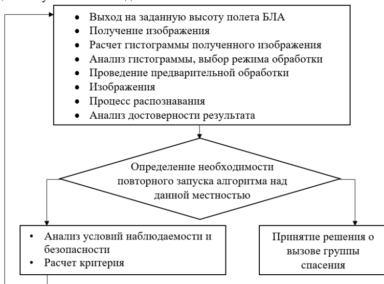
Рис.5. Функциональная схема адаптивного мониторинга
