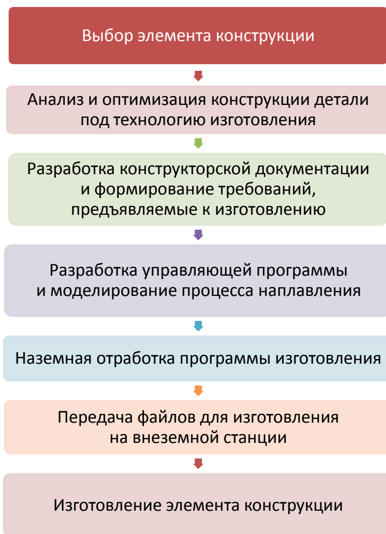
Рисунок 2.1 – Методика изготовления конструктивных элементов КА
