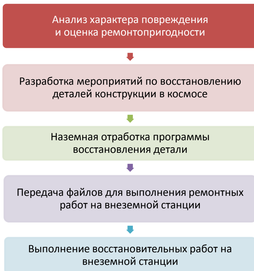
Рисунок 2.9 – Методика ремонта элементов конструкции
