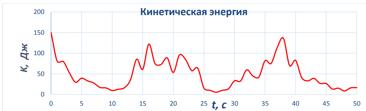
Рисунок 4.11 – Полная кинетическая энергия манипулятора, Дж
