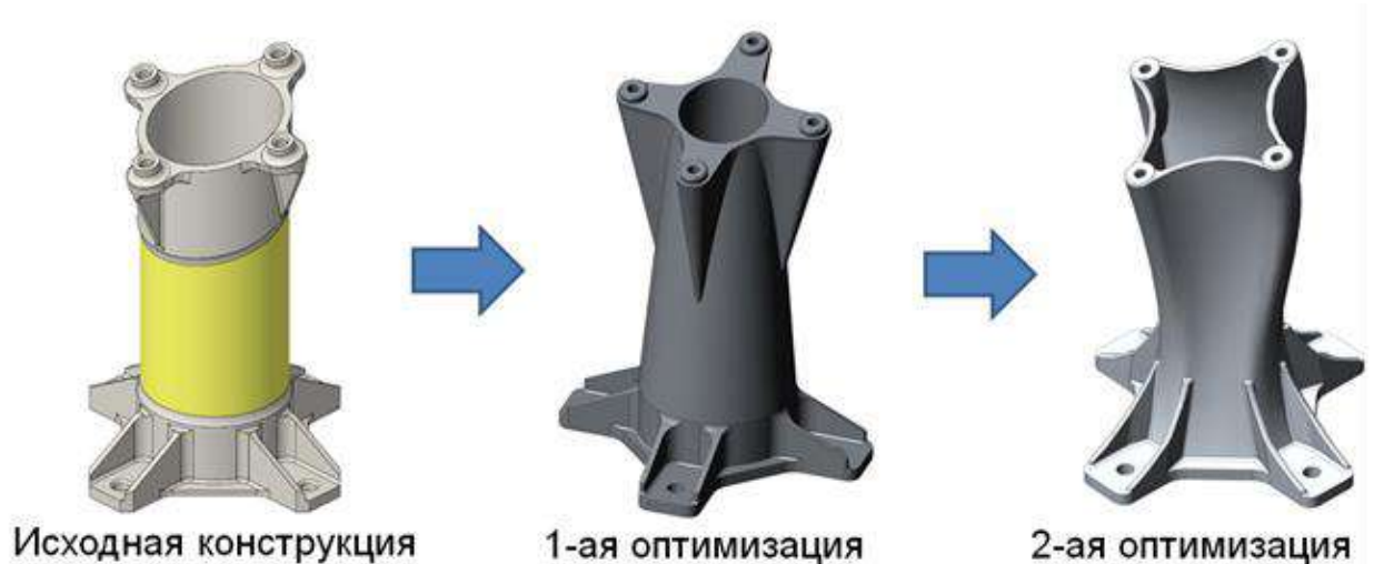
Рисунок 3.4 – Этапы технологической оптимизации элемента конструкции
