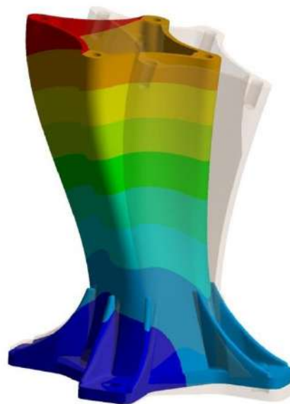
Рисунок 3.20 – Первая форма колебаний модели, частота 66 Гц
