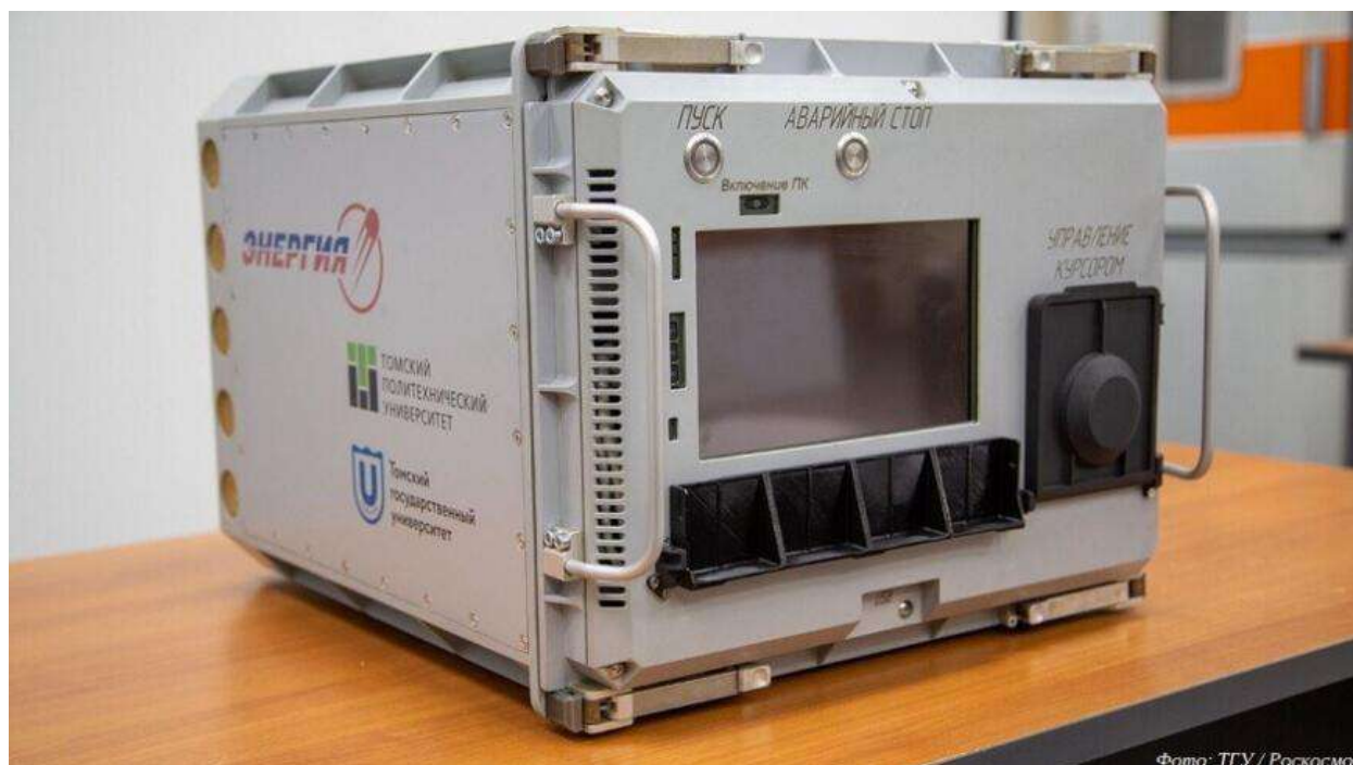
Рисунок 1.2 – FDM-принтер, установленный на PC MKS [16]
