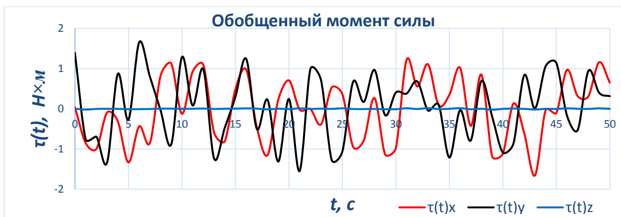
Рисунок 4.10 – Обобщенный момент силы в рабочем органе, Н×м
