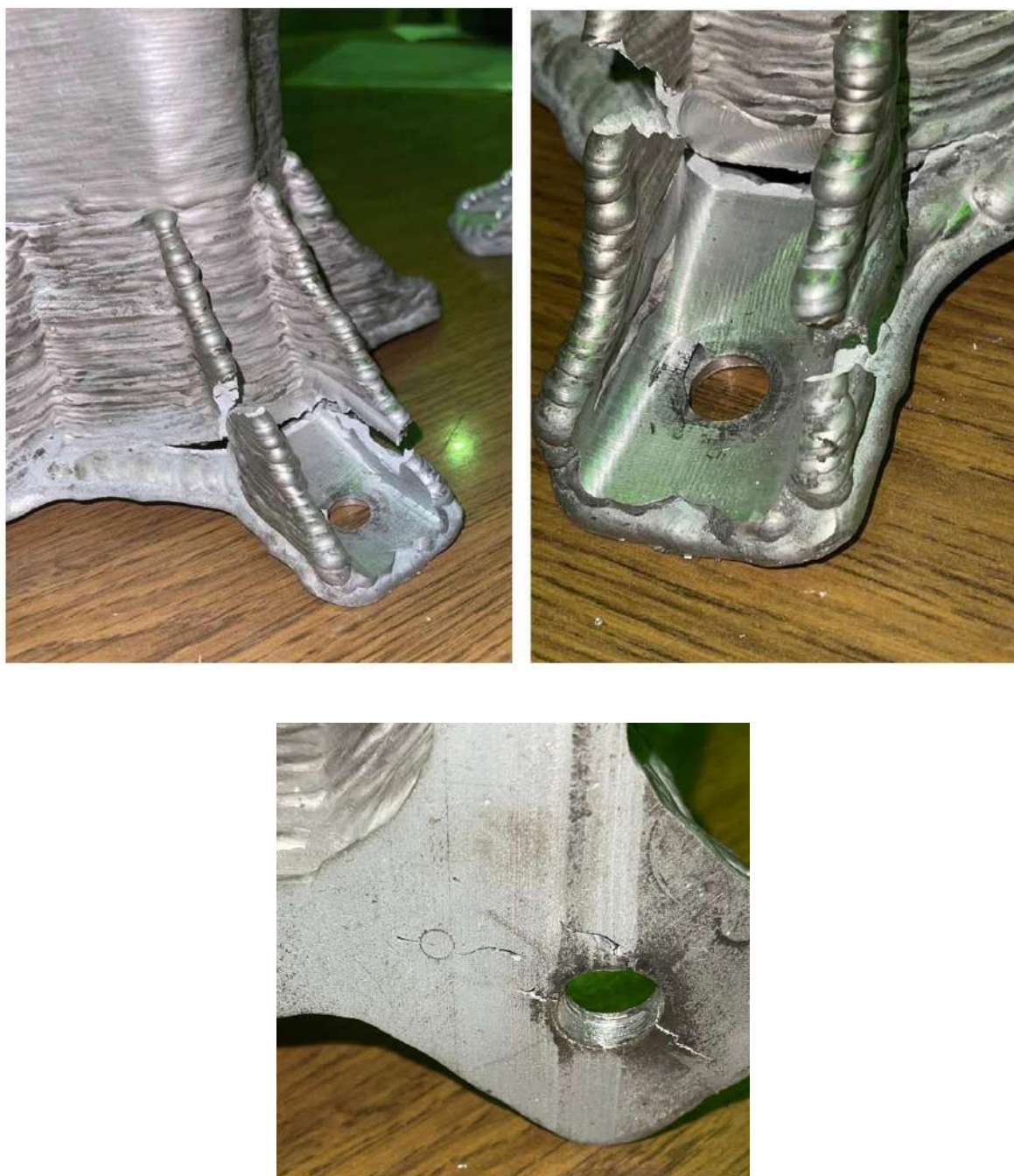
Рисунок 3.24 – Разрушение экспериментального элемента
