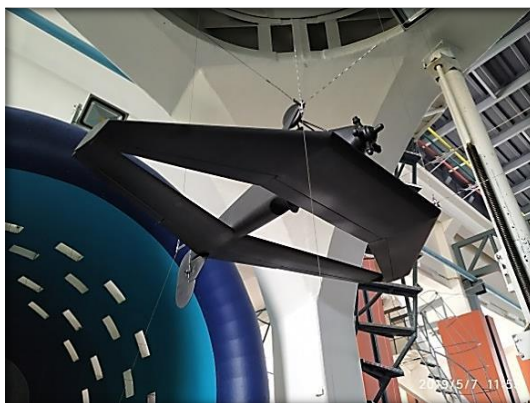
Рисунок 3-24 – Весовая модель самолета По-2 с модифицированным сочлененным крылом в аэродинамической трубе МАИ Т-1
