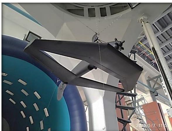
Рисунок 3-13 – Весовая модель самолета По-2 с модифицированным сочлененным крылом в аэродинамической трубе МАИ Т-1
