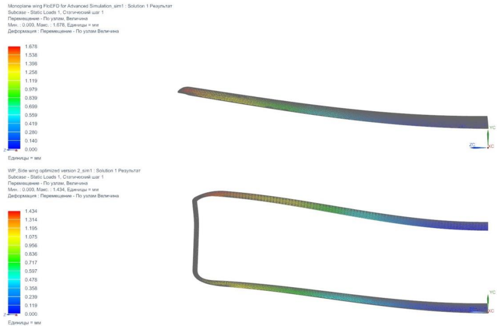
Рисунок 4-12 – Напряженно-деформированное состояние расчетных моделей; визуализация деформации
