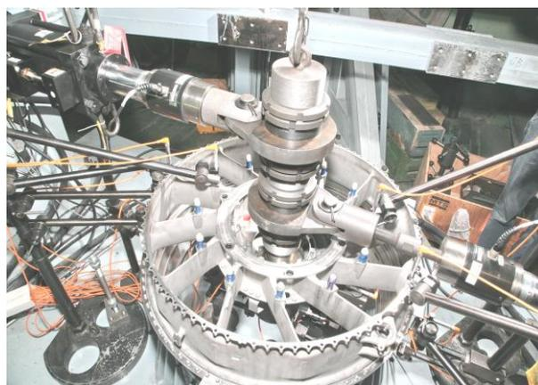
Рис.22. Закреплённая в оснастке конструкция ЗСУ с присоединёнными корпусами опоры подшипника и ТНД
