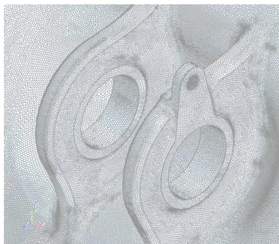
Рис.15. Фрагмент КО-сетки ЗСУ со средним размером ячейки 1 мм
