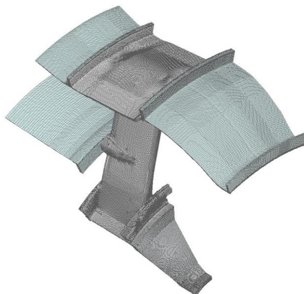
Рис. 5. КЭ модель сектора с автоматически измельченной сеткой (740000 КЭ)
