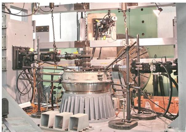
Рис.21. Экспериментальная установка для определения податливости
