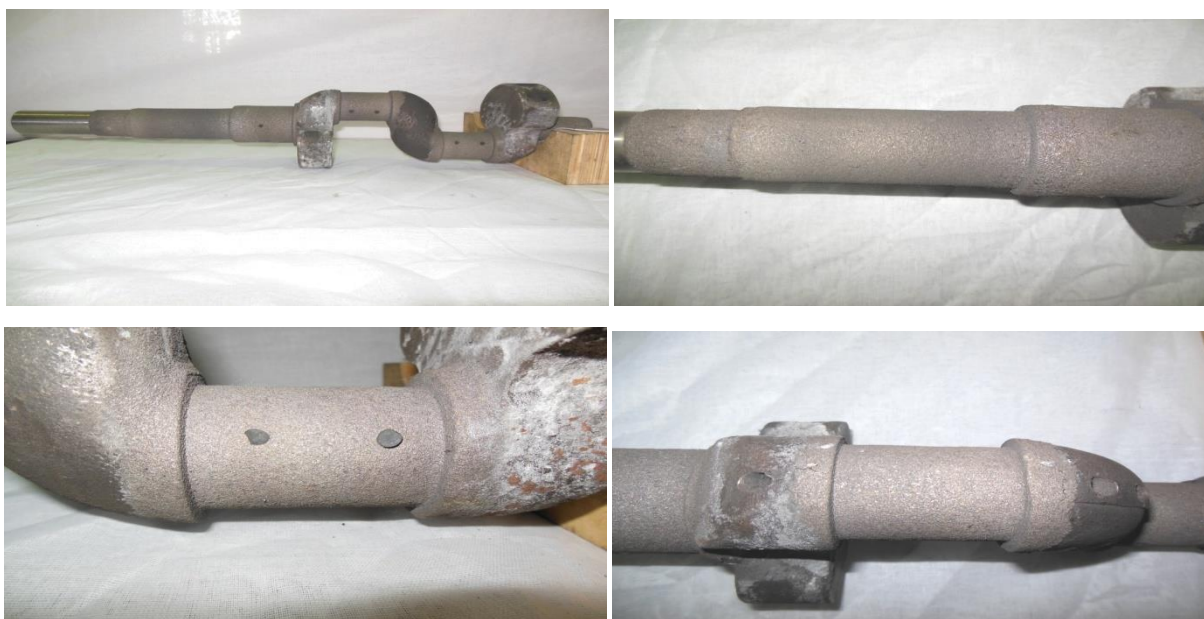
Рисунок 5.1. Внешний вид шеек вала привода компрессора климатической установки пассажирского вагона непосредственно после электродуговой металлизации
