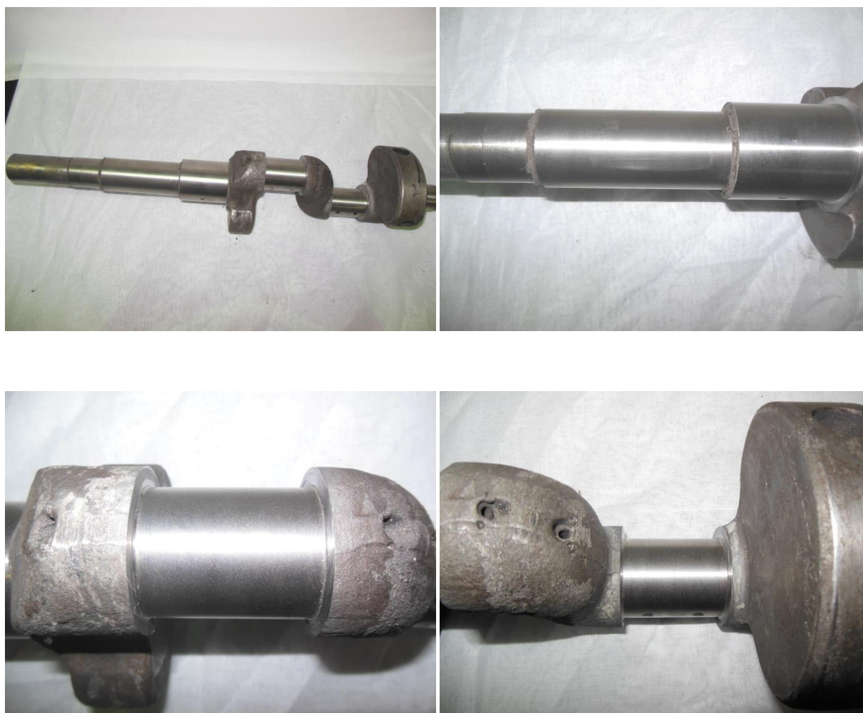
Рисунок 5.2. Внешний вид шеек вала привода компрессора климатической установки пассажирского вагона непосредственно после электродуговой металлизации и механической обработки
