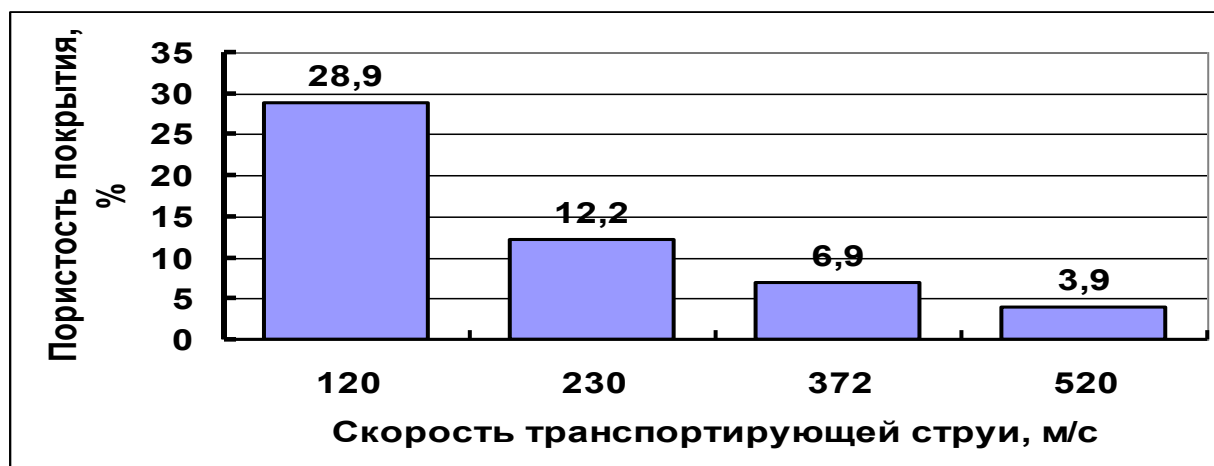
Рисунок 5.4. Влияние скорости истечения транспортирующей струи из сопла металлизатора на пористость слоя покрытия на шейках вала привода компрессора климатической установки пассажирского вагона
