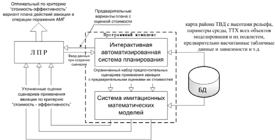
Рис.1. Функциональная схема взаимодействия ЛПР с компонентами программного комплекса имитационных математических моделей операций поражения КГ
