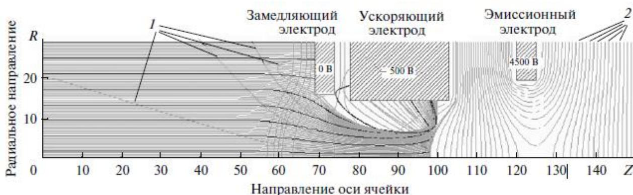
Температура электронов  $T_e = 5$  эВ, ток ячейки  $I = 5.57 \times 10^{-5}$  А; ток ионов перезарядки составляет 1% от тока ионов пучка. Масштаб координатной сетки  $\text{мм} \times 10$ .
