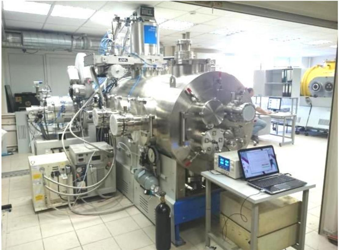
Рисунок 4.17 - Вакуумный стенд ИУ-2
