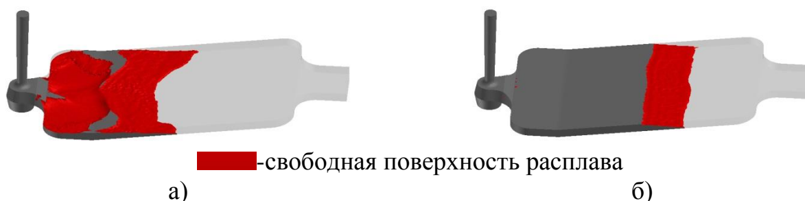
Рисунок 2.3 – Результат моделирования процесса заполнения формы: а–I этап; б–II этап
