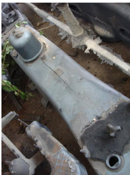
Рисунок 4.16 – Балка надрессорная с горячей трещиной по верхнему поясу.
