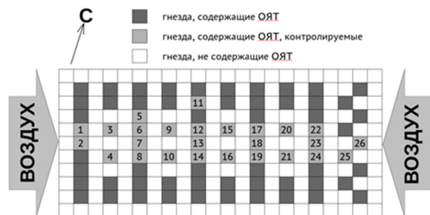
Рис. 4. Схема контролируемых гнезд хранения ОЯТ ВВЭР-1000 камеры № 2 (вид сверху)
