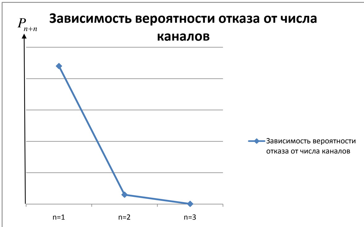
Рис. 1 . Зависимость вероятности отказа от числа каналов в беспriorитетном обслуживании
