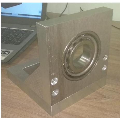
*Рис. 5. Устройство фиксации с подшипником.*
