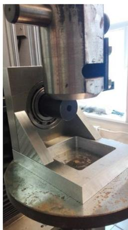
*Рис. 8. Система подшипник-УФП-штанга и нагружающее устройство*
