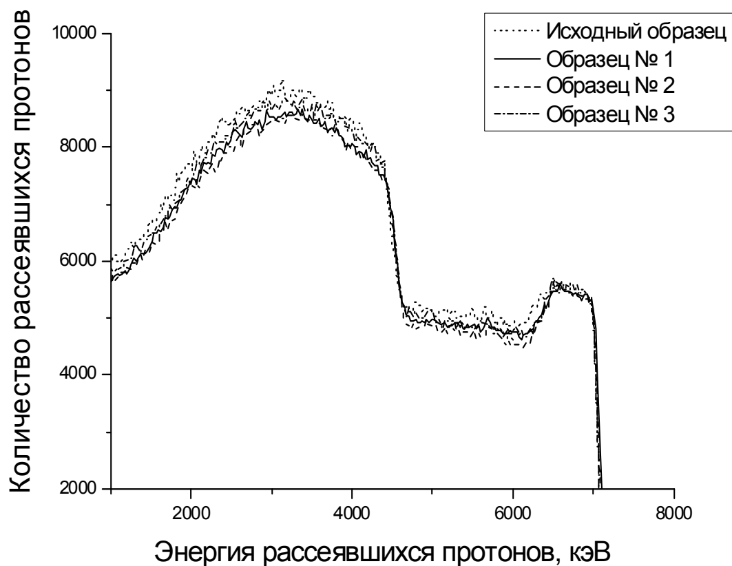
Рис. 5 Спектры ЯОП для образцов № 1, 2, 3 и исходного ненаводороженного образца. Образцы № 1, 2, 3 отобраны из разных точек объема и в силу больших объемов спекаемого порошка содержание водорода в данных образцах различно.
