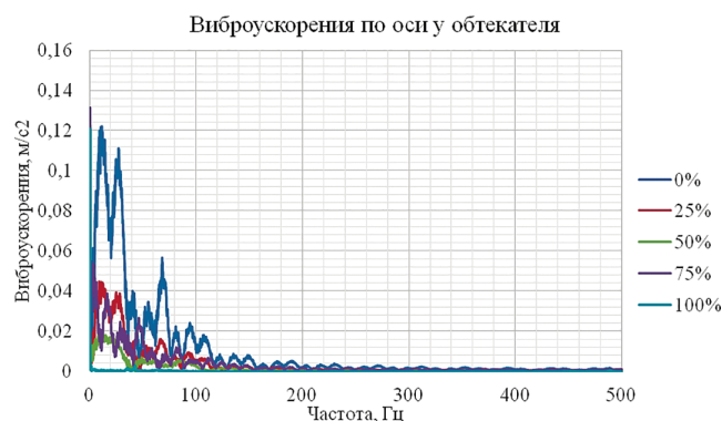
Рис. 6. Графики спектральной плотности, отражающие влияние плотности и вязкости гелиевой среды в разной концентрации на виброустойчивость движения объекта испытания в вертикальном направлении
