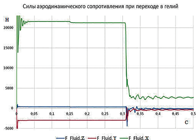
Рис. 4. Графики изменения аэродинамических сил при вхождении в гелиевый участок
