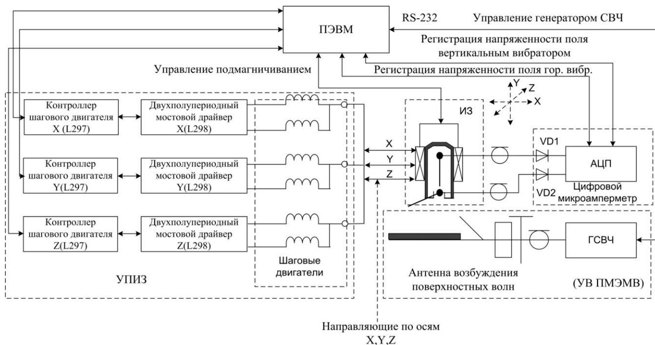
Рис. 5. Функциональная схема измерительной системы
