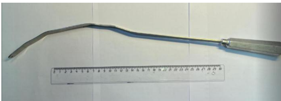
Рисунок 4.13 – Направитель с переменной жесткостью из никелида титана, подвергнутого локальной термической обработке по схеме I.
