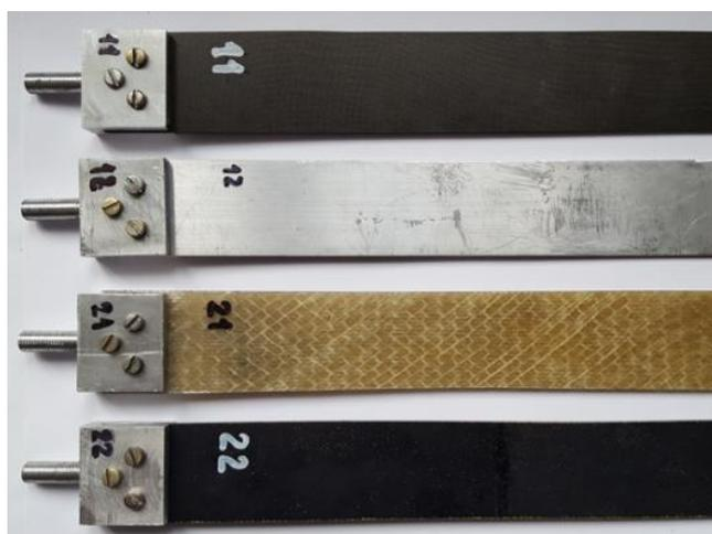
Рисунок 3. Экспериментальные образцы модели лопасти, выполненные из углепластика (11), алюминия (12), стеклопластика (21) и базальтового волокна (22)
