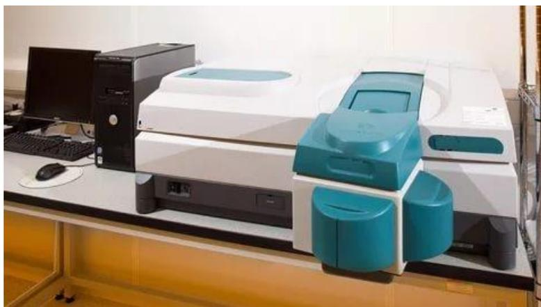
*Рисунок 2.16. Спектрофотометр CARY-5000 (UV-VIS-NIR) с приставкой диффузного отражения*
