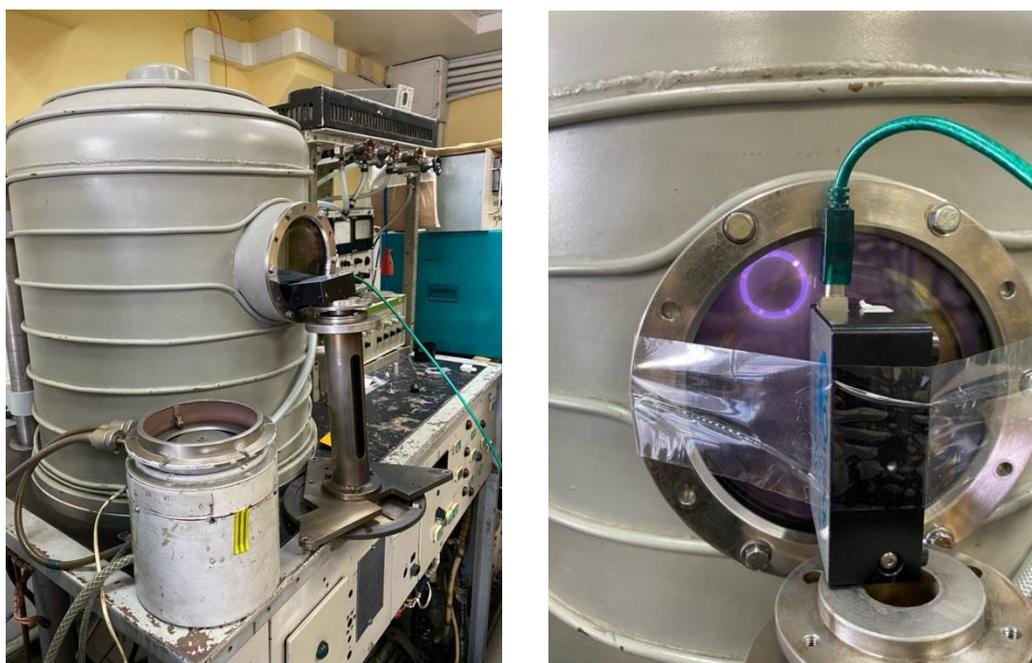
Рисунок 3.5. Крепление оптоволоконного спектрометра Ocean Optics USB4000 к смотровому окну вакуумной камеры
