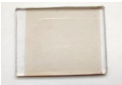
*Рисунок 3.13. Образец полистирола, подготовленный для оптического контроля, с нанесенной пленкой  $CF_4(60\%)+C_6H_{12}(40\%)$*
