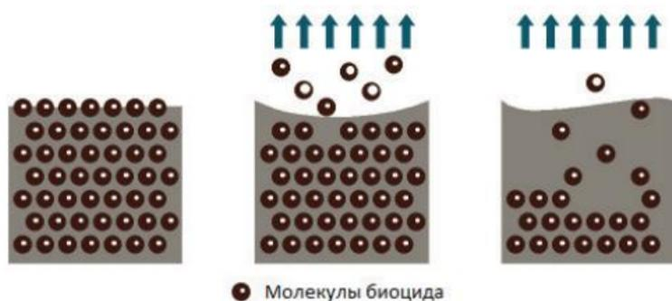
Рисунок 1.6. Принцип действия высвобождающей поверхности [77]
