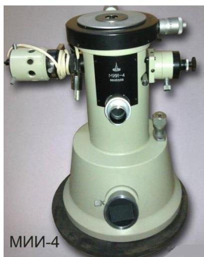
Рисунок 2.10. Микроинтерферометр МИИ-4
