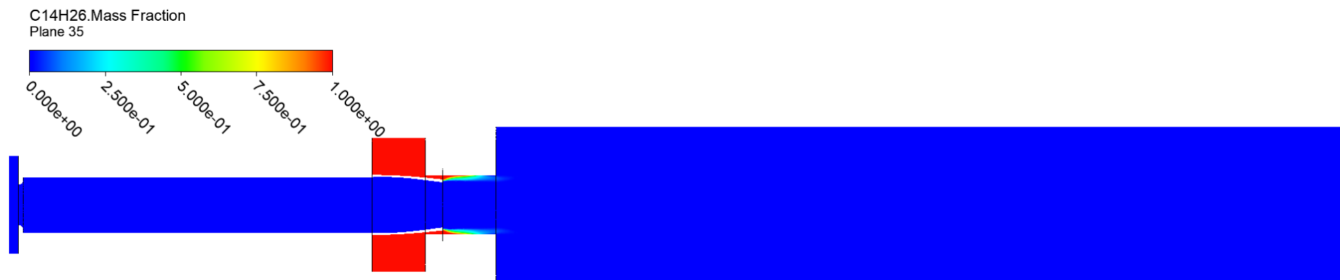
Рисунок 24 – Распределение массовой доли горючего в продольной плоскости форсунки с некруглым 6-и лучевым выходным сопловым каналом
