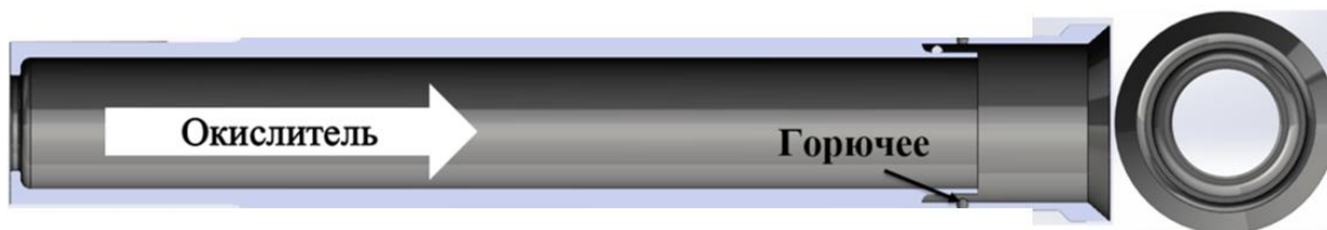
Рисунок 15 – Форсунка струйно-центробежная круглого сечения выходного соплового канала
