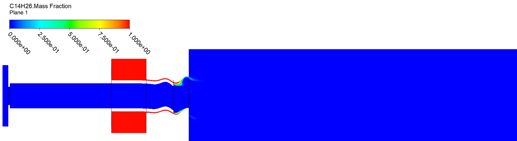
Рисунок 56 – Распределение массовой доли горючего в продольной плоскости форсунки с некруглым 5-и лучевым выходным сопловым каналом с закруткой
