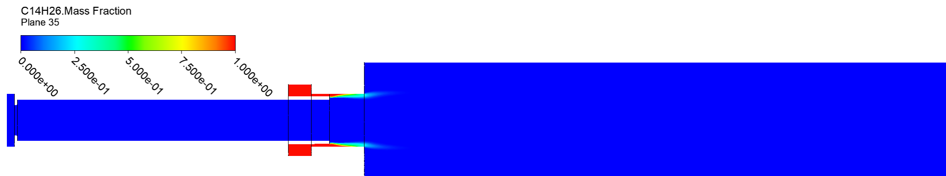
Рисунок 25 – Распределение массовой доли горючего в продольной плоскости форсунки с некруглым 10-и лучевым выходным сопловым каналом
