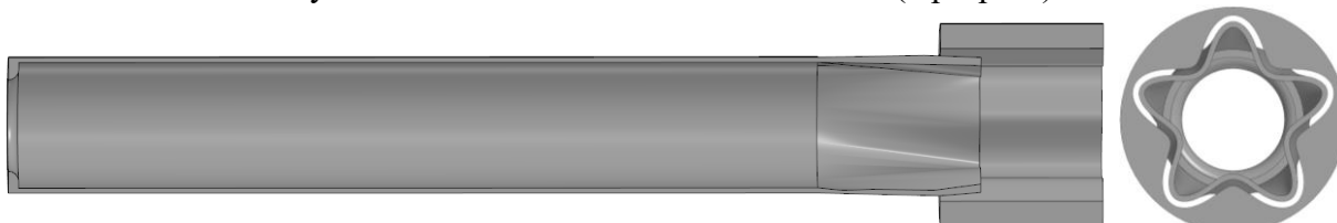
Рисунок 8 – Коаксиальная двухкомпонентная газожидкостная форсунка с некруглым 5-и лучевым выходным сопловым каналом (в разрезе)
