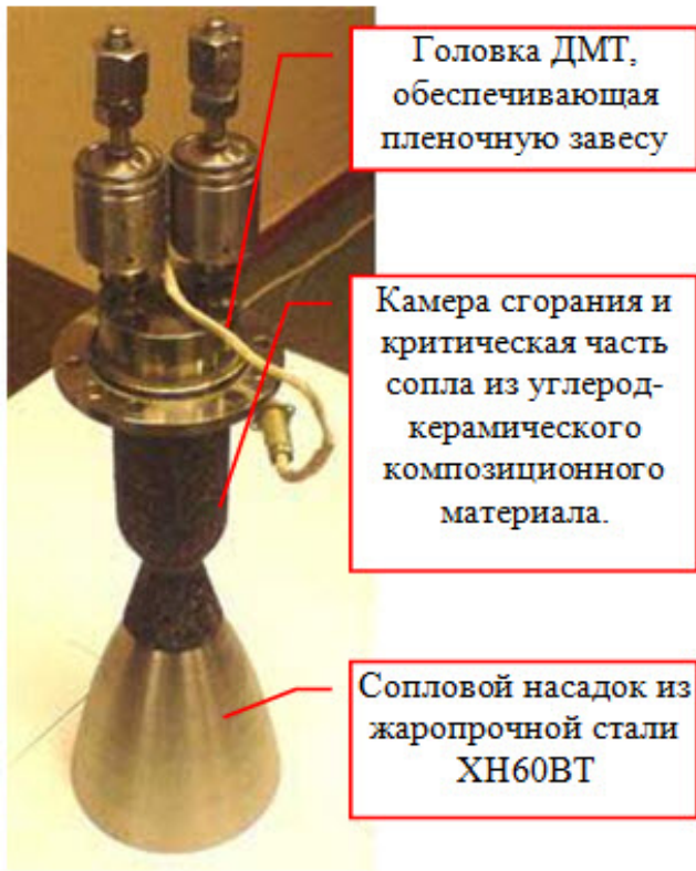
Рис. 9. Макет двигателя МАИ-202К-200-1 разработки МАИ в сборе с керамо-композитной камерой
