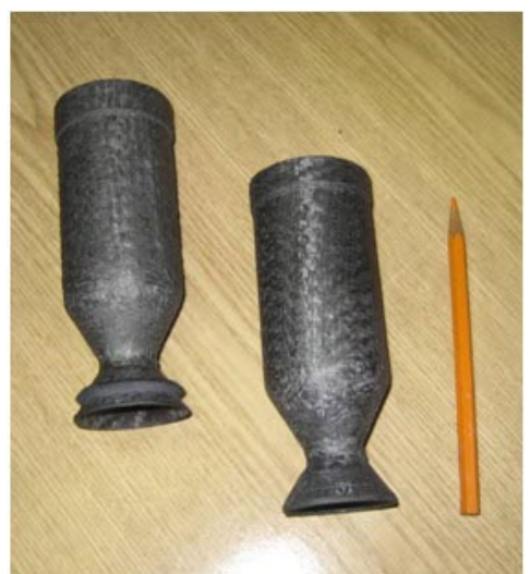
Рис. 8. Заготовки керамо-композитных камер сгорания
