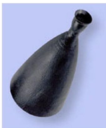
Рис. 5. Камера сгорания и сопло двигателя European Apogee Motor сделаны единой конструкцией
