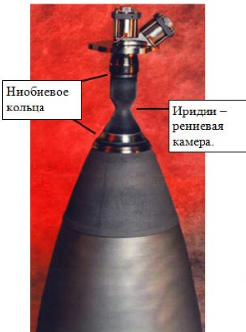
Рис. 3. Двигатель NiPAT с иридий-рениевой КС
