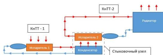
Рис. 2. Схема теплопровода, состоящая из двух КнТТ
