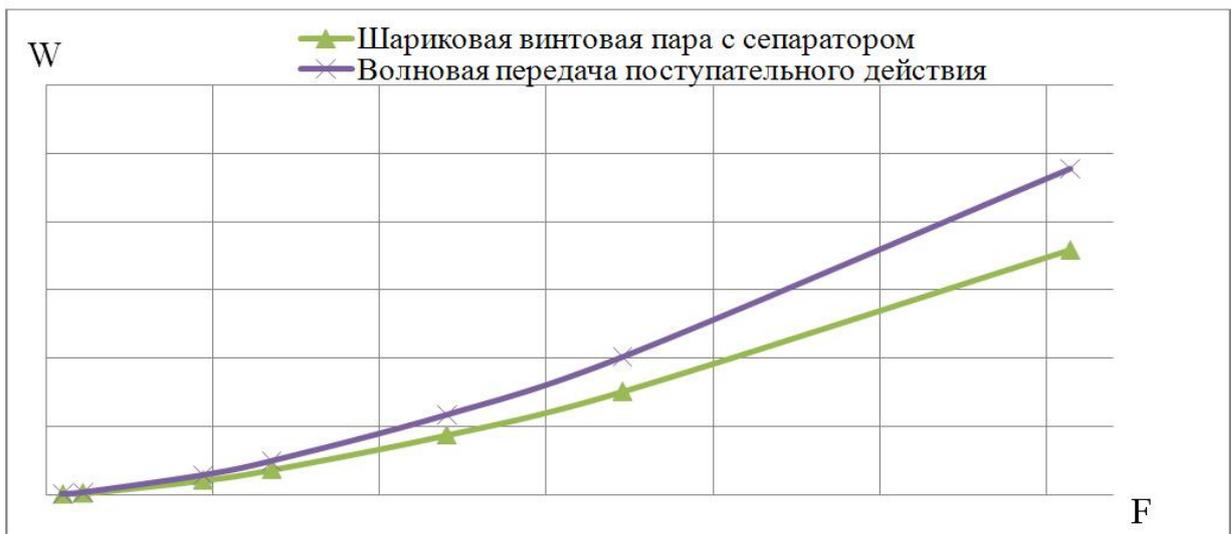
Рис. 4. Зависимости объемов механических передач поступательного действия от развиваемого усилия
