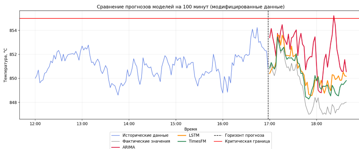
Рисунок 9 — Прогноз LSTM без реконструкции для объекта 1
