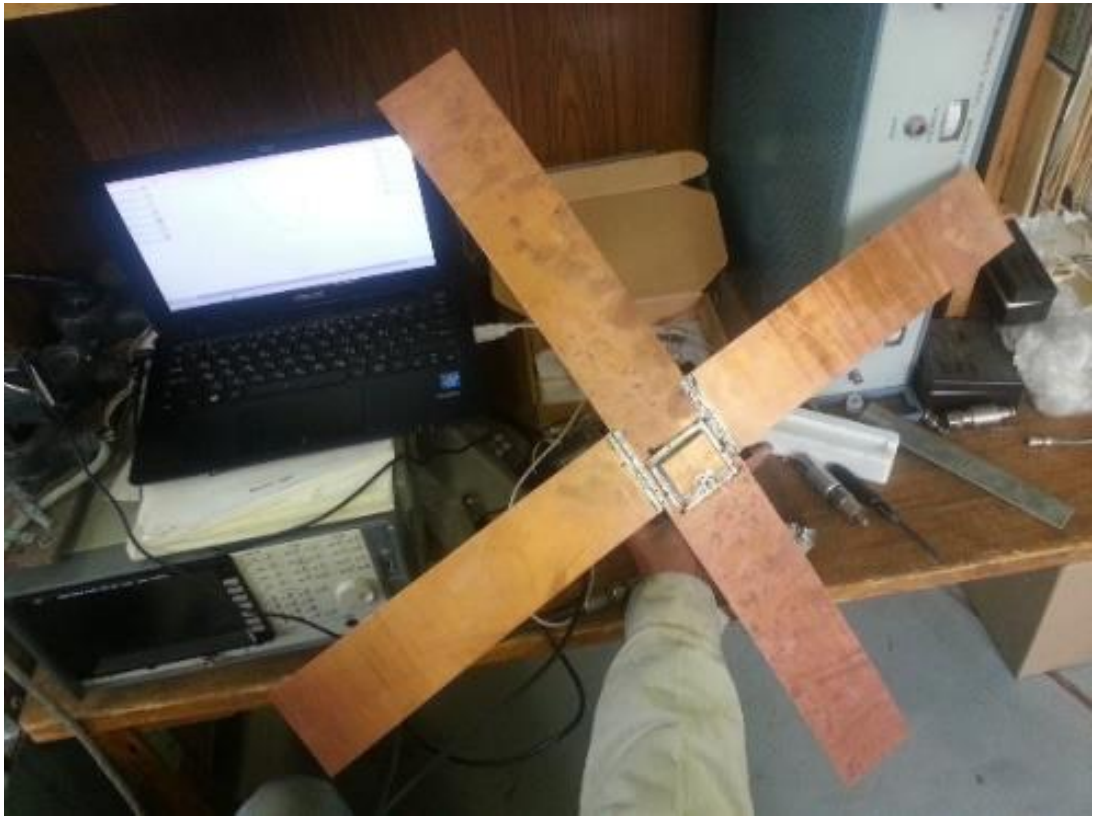
Рис. 1.8. Фотография макета КА «CubeSat» с образцом МПА.
