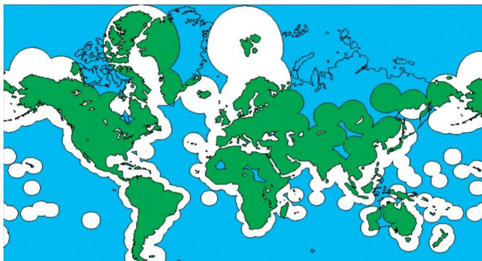
Рисунок 17 – Допустимые области полета для двухдвигательного самолета, не сертифицированного по ETOPS
