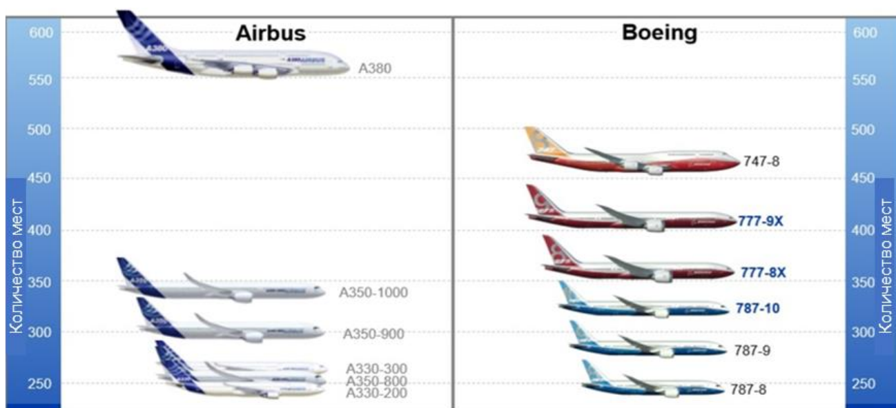
Рисунок 20 – Пассажировместимость самолетов Boeing и Airbus
