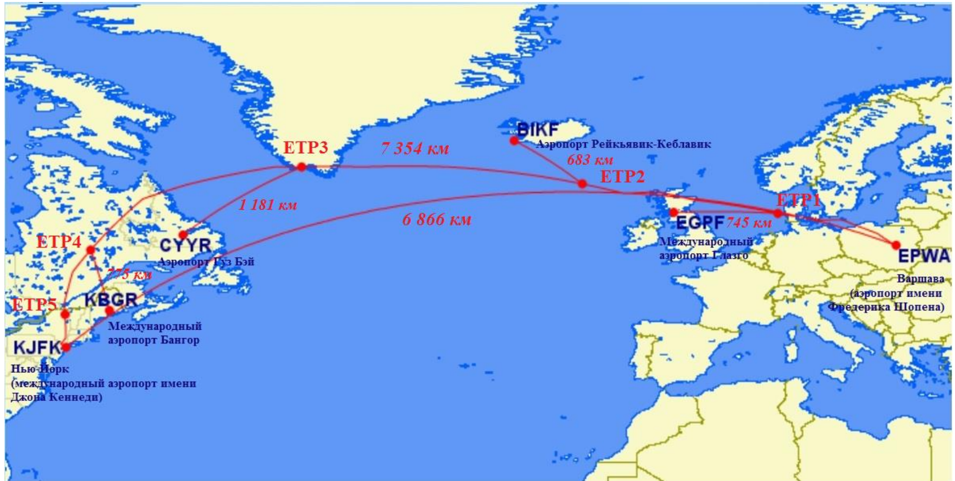
Рисунок 19 – Маршрут полета Варшава (аэропорт имени Фредерика Шопена) – Нью-Йорк (международный аэропорт им. Джона Кеннеди) на двухдвигательном самолете с пороговым временем 180 минут и ортодромическое расстояние
