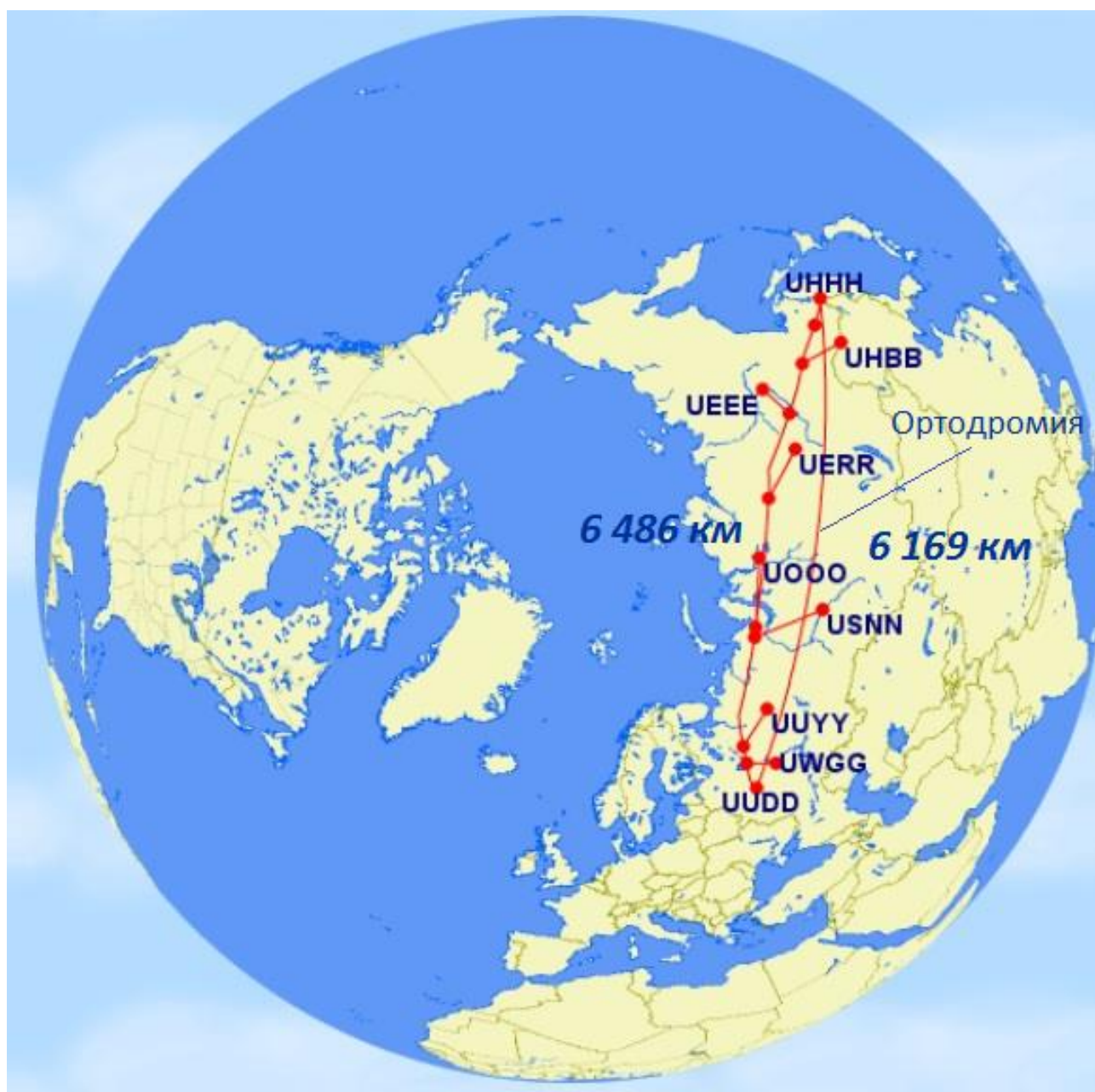
Рисунок 23 – Маршрут полета UDDD-UHHH на двухдвигательном самолете с пороговым временем 90 минут и ортодромическое расстояние
