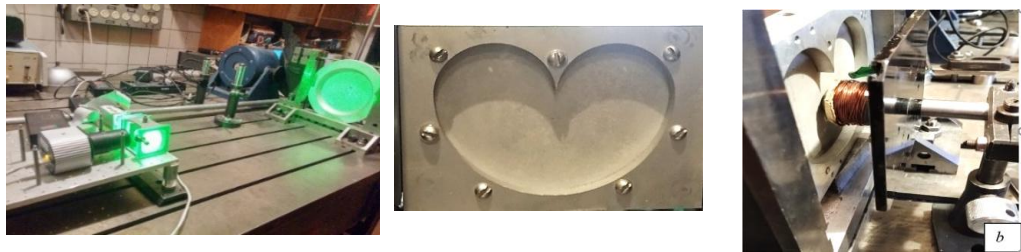
Рисунок 10 – Оптико-акустический стенд: слева - оптический блок, в центре - один из образцов, справа - часть акустического блока для возбуждения и регистрации резонансных частот колебаний с тыльной стороны образца
