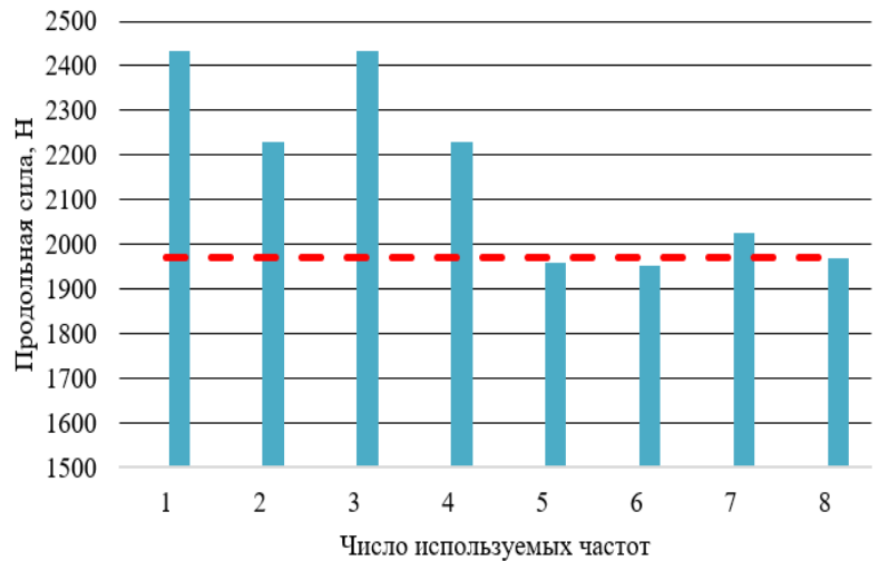
Рисунок 6 – Значения продольной силы, определённые динамическим методом по одной первой, двум,..., восьми собственным частотам; штриховой линией показано значение продольной силы, заданное в растягивающей установке
