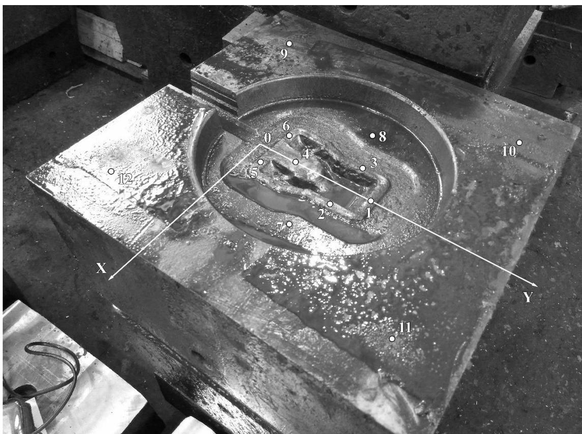
Рисунок В3 – Нижний штамп для поковки «вилка», замер 3
