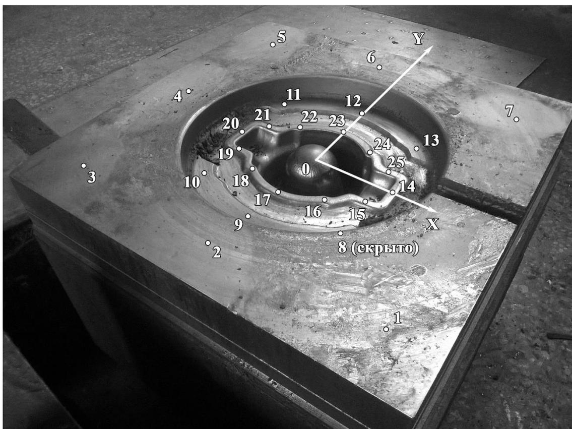
Рисунок В38 – Верхний штамп для поковки «корпус кардана», замер 2
