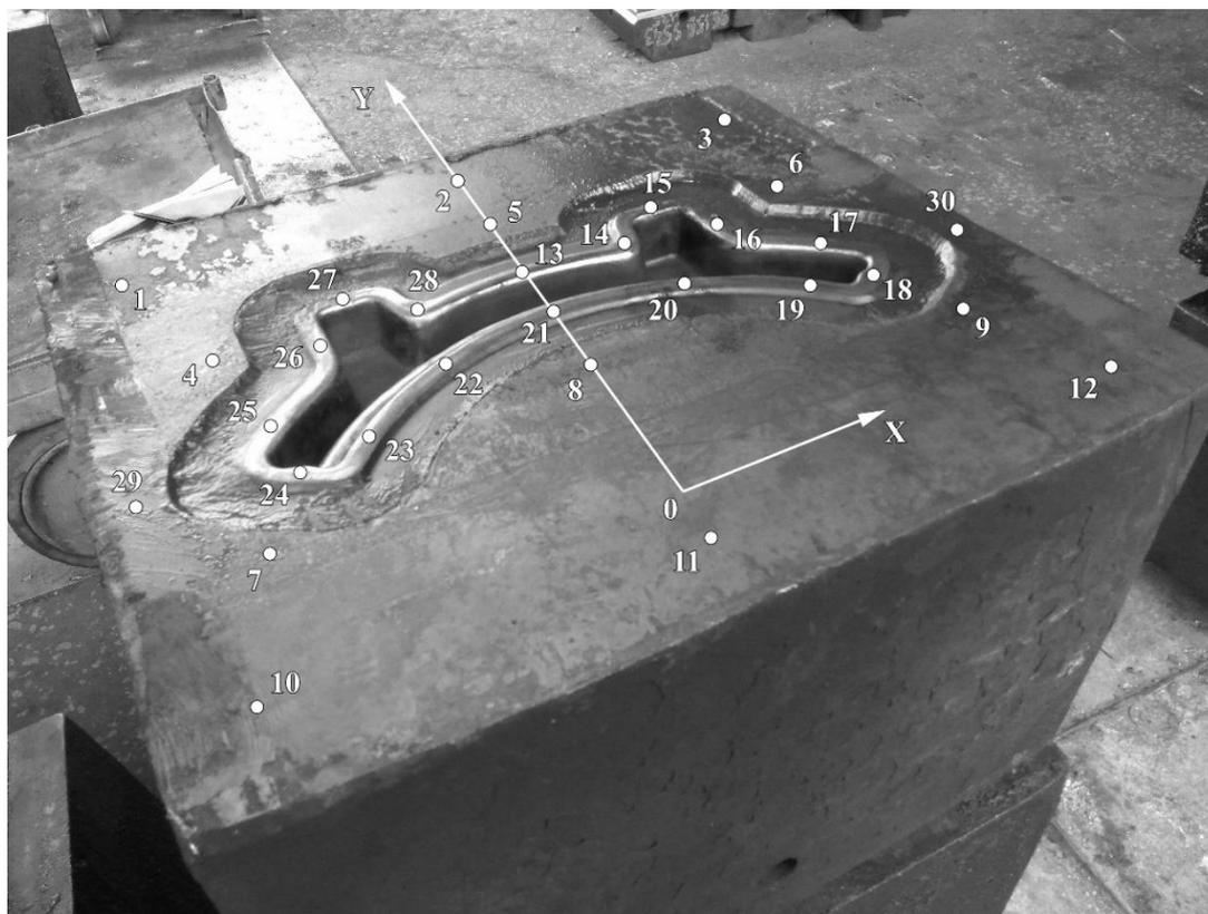
Рисунок В29 – Нижний штамп для поковки «бугель», замер 5
