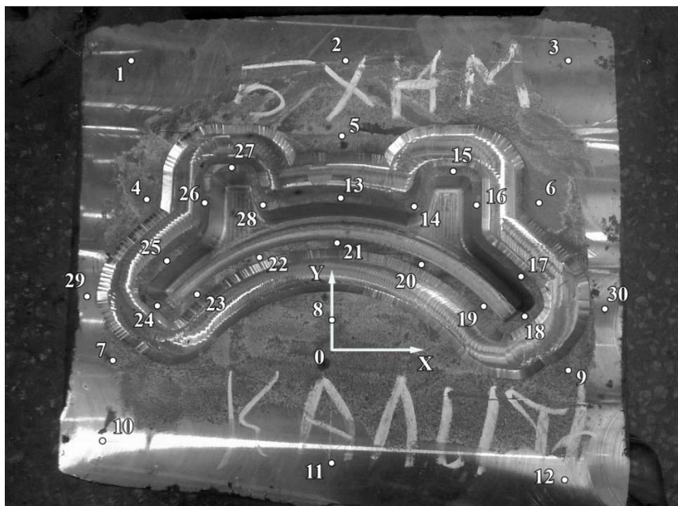
Рисунок В25 – Нижний штамп для поковки «бугель», замер 1
