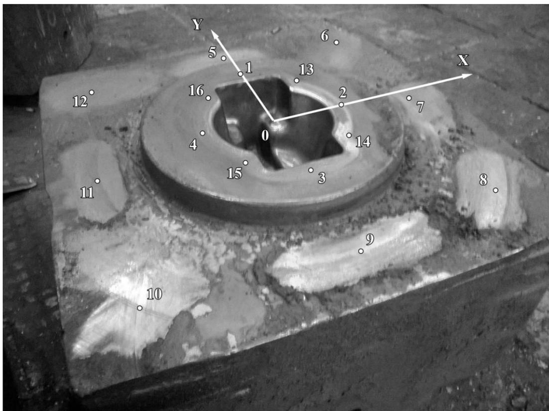
Рисунок В16 – Нижний штамп для поковки «корпус», замер 3
