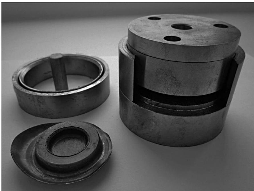
Рисунок 16 – Набор экспериментальной технологической оснастки и полученная поковка
