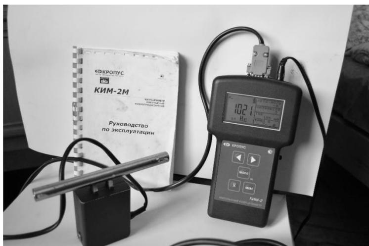
Рисунок 7 – Коэрцитиметр КИМ-2М в процессе измерения коэрцитивной силы изделия цилиндрической формы
