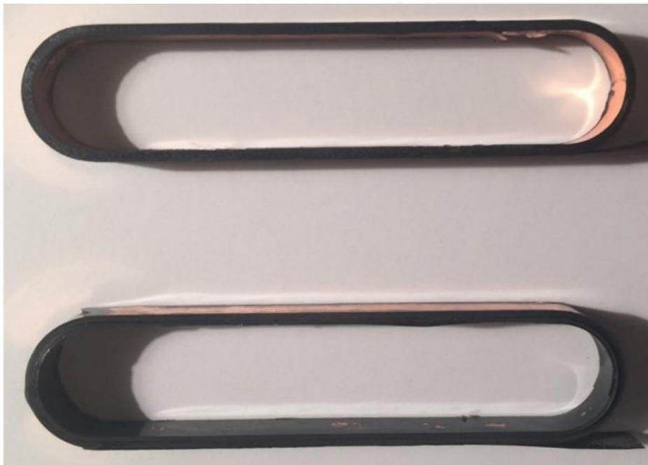
Рисунок 3.3 – Технологические обмотки из ВТСП-ленты
