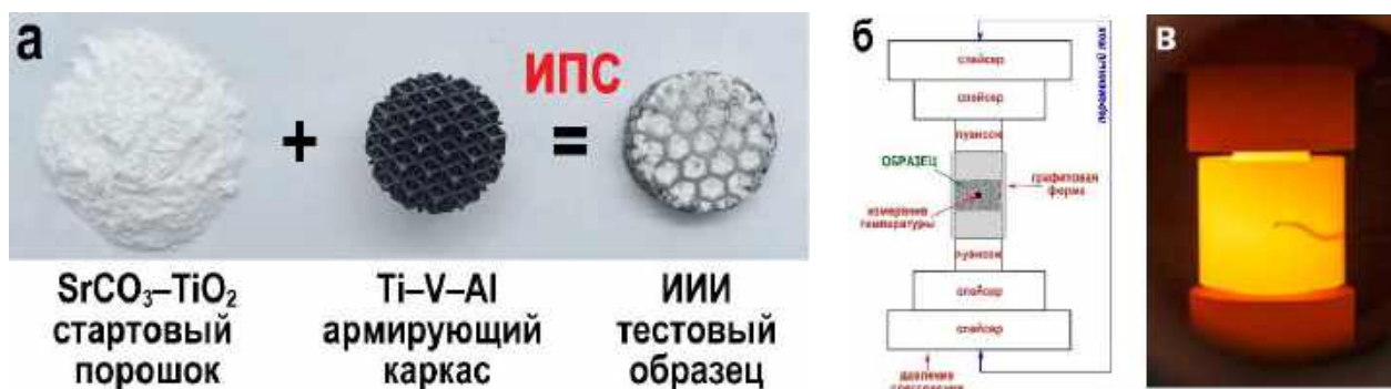
Рисунок 4.20 - Общая схема получения опытного изделия ИИИ-открытого типа по технологии реакционного ИПС: (а)- заготовки и конечное изделие; (б)- схема ИПС процесса; (в)- разогрев пресс-формы с изделием
