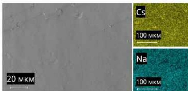
Рисунок 3.43 - РЭМ изображения и ЭДС анализ поверхности срезов образцов керамики, содержащей 26,1 мас.% цезия, полученных консолидацией синтетического цеолита Na-Y методом ГП при 1000 °С и времени выдержки 5 мин
