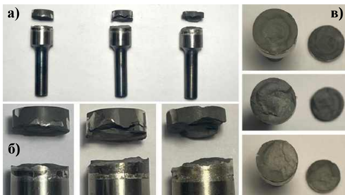
Рисунок 5.49 - Общий вид образцов ФГМ с неразъемным соединением после испытаний на определение предела прочности при сдвиге (а), области разрушения образцов (б) и вид поверхности областей разрушения (в)
