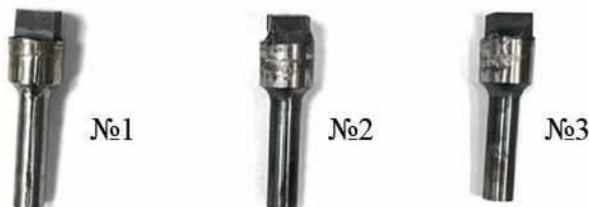
Рисунок 5.42 - Общий вид образцов ФГМ с неразъемным соединением “Композит-1600—ЖС6У-ВИ”, полученных по технологии ИПС, с различной толщиной связки Ti-Ag: 2 мм (образец №1 и №2); 1 мм (образец №3)
