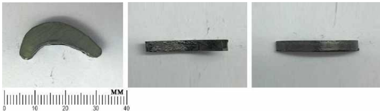
Рисунок 2.7 - Образец заготовки SiC-керамики профиля лопатки турбины, полученного по технологии ИПС
