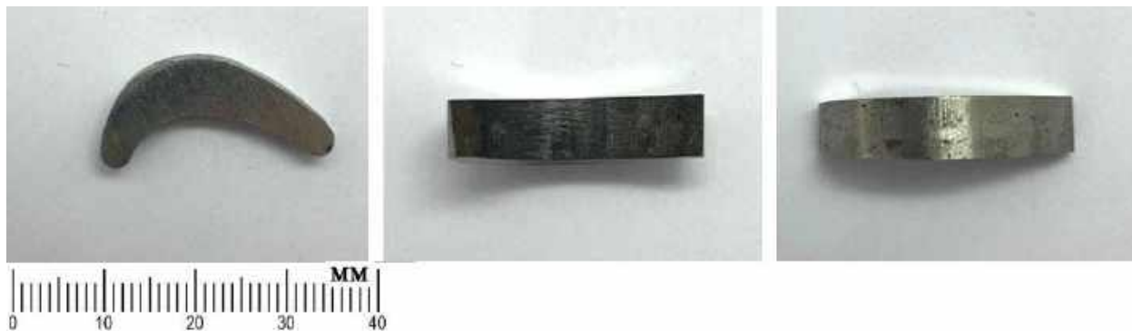
Рисунок 2.8 - Образец заготовки стали X18H15 профиля лопатки турбины, полученного по технологии ИПС
