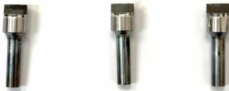
Рисунок 5.45 - Общий вид образцов ФГМ с неразъемным соединением на основе SiC-керамики в составе с 10 мас.% SiCw вискером и жаропрочного сплава ЖС6У-ВИ (образцы SiC/SiCw—ЖС6У-ВИ), полученных по технологии ИПС
