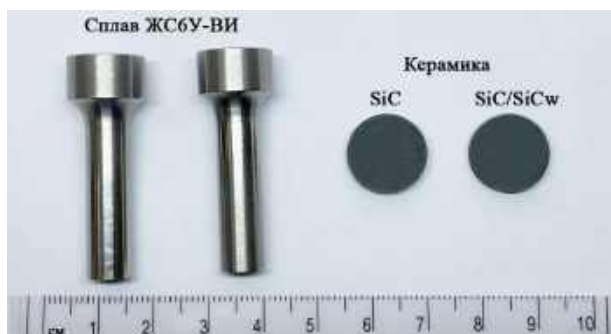
Рисунок 2.3 - Общий вид образцов жаропрочного сплава ЖС6У-ВИ и образцов SiC-керамики и ее армированной формы SiC/SiCw, полученных ИПС
