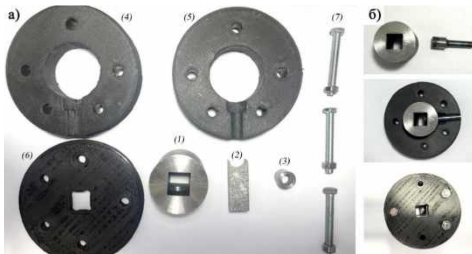
Рисунок 5.47 - Общий вид комплекта изготовленной оснастки для испытаний на определение предела прочности при сдвиге (а) и сборка оснастки с установкой образца ФГМ для испытаний (б). Описание нумерации комплектующих представлено в тексте
