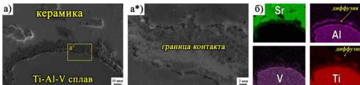
Рисунок 4.22 - РЭМ изображения (а, а*) и ЭДС анализ (б) с поверхности опытного образца изделия ИИИ-открытого типа
