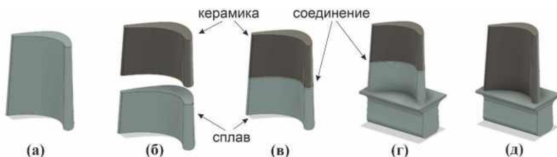
Рисунок 5.50 - 3D модели: (а)- лопатка ГТД; (б)- фрагменты ФГМ профиля лопатки из керамики и сплава/стали; (в)- ФГМ с неразъемным соединением; (г, д)- пример конструкции лопатки ГТД с замком на основе ФГМ с неразъемным соединением
