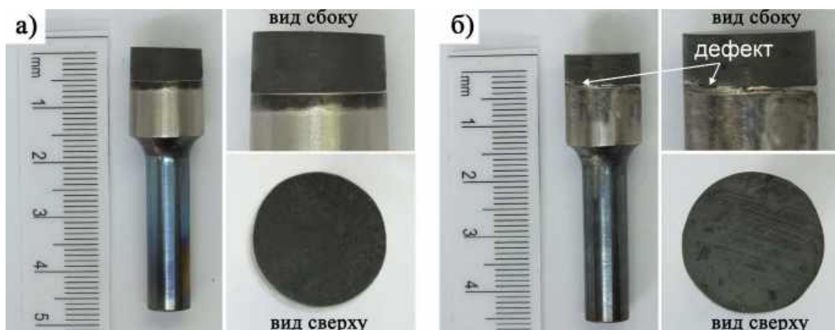
Рисунок 5.32 - Общий вид ФГМ с неразъемным соединением на основе SiC-керамики и ЖС6У-ВИ, полученных ИПС: (а)- керамика без армирующей добавки (образец SiC—ЖС6У-ВИ); (б)- керамика с армирующей добавкой (SiC/SiCw—ЖС6У-ВИ)
