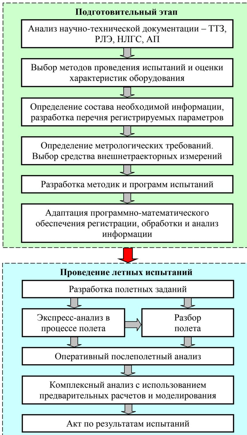
Рисунок 2. Структурная схема организации испытаний.
