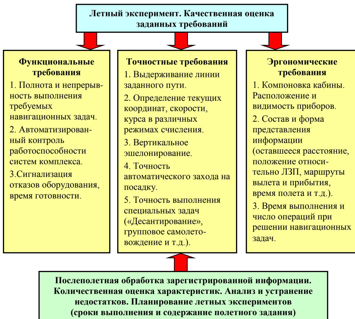
Рисунок 5. Структурная схема комплексного анализа задач самолетовождения.
