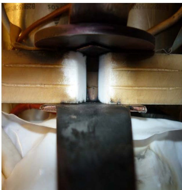
Рисунок 5. Фотография разрядного канала двухступенчатого АИПД рельсовой схемы
