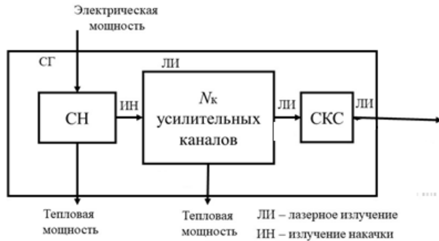
Рисунок 3.3 – Функциональная схема СГ ЛС с технологией когерентного сложения лазерного излучения, генерируемого N_k усилительными каналами
