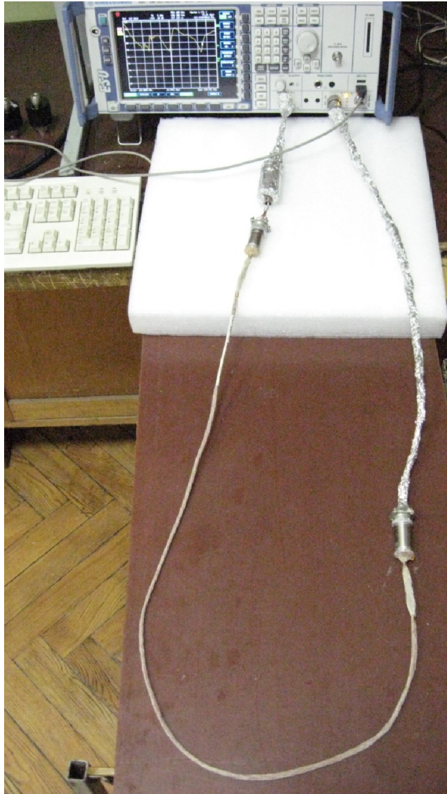
Рис. 47. Установка для исследования сопротивления связи и эффективности экранирования на основе коаксиальной схемы.
