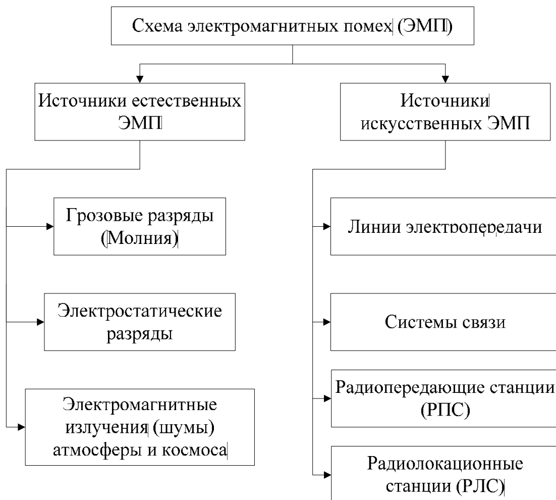
Рис. 2. Классификация источников электромагнитных помех, воздействующих на электротехнические комплексы летательных аппаратов
