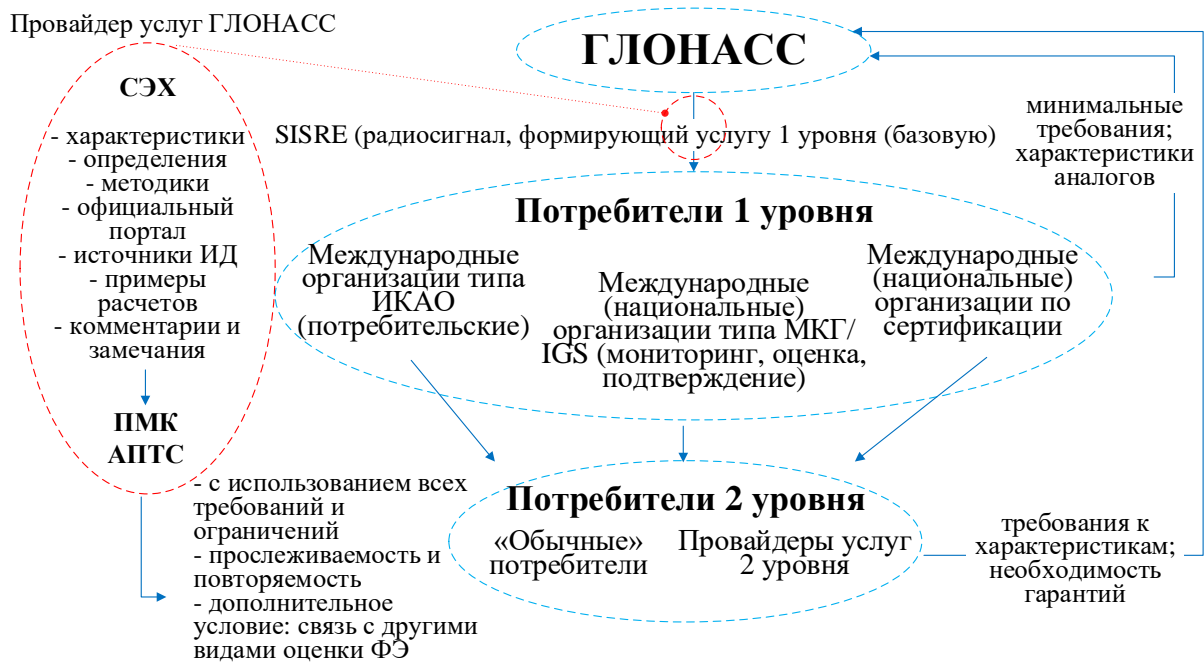
Рисунок 3 – Общий подход к оценке функциональной эффективности с помощью эксплуатационных характеристик на примере системы ГЛОНАСС
