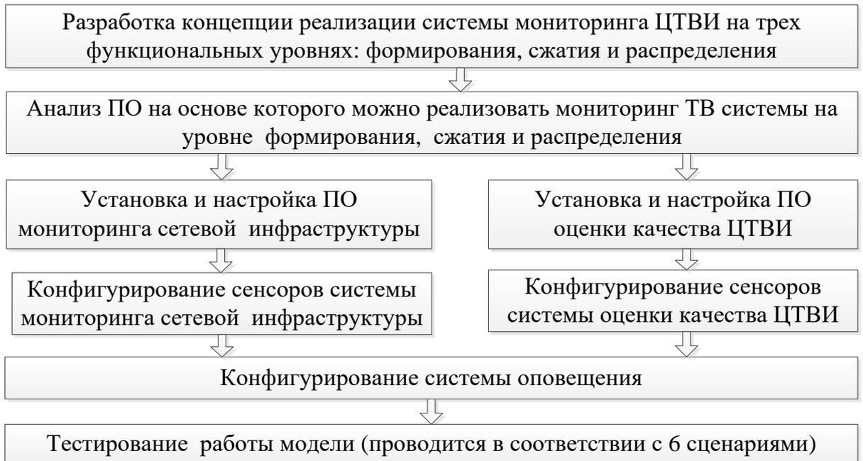
Рисунок 3.1. Принципиальная схема процесса разработки модели системы мониторинга ЦТВИ в НКУ РС МКС
