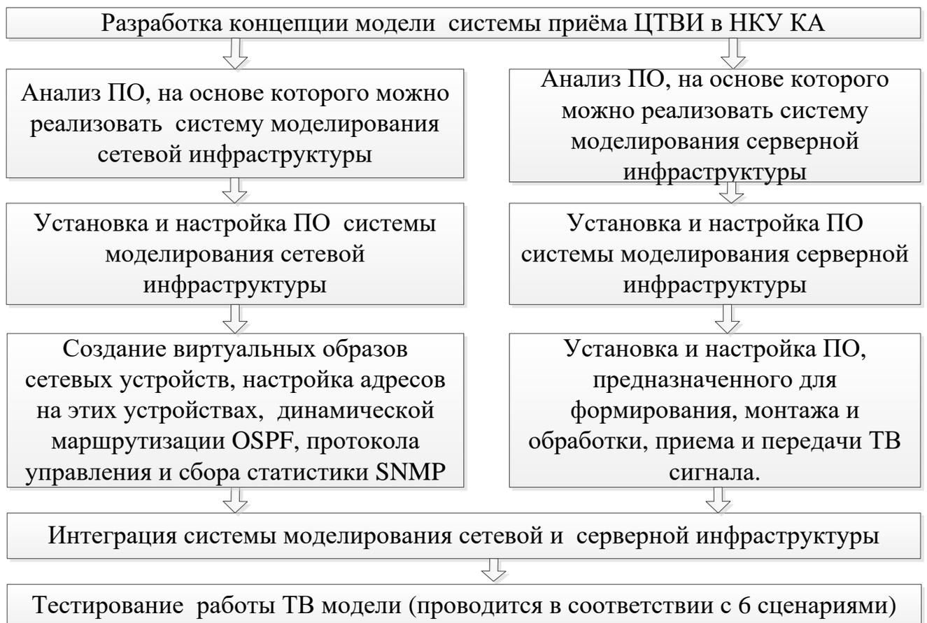
Рисунок 2.3. Принципиальная схема процесса разработки модели системы приёма ЦТВИ в НКУ РС МКС
