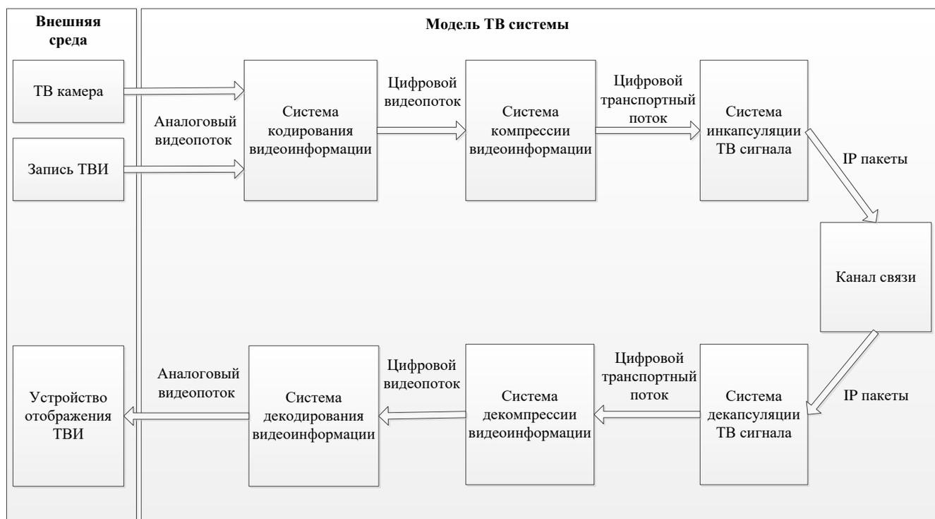
Рисунок 2.1. Функциональная схема модели ТВ системы в НКУ РС МКС
