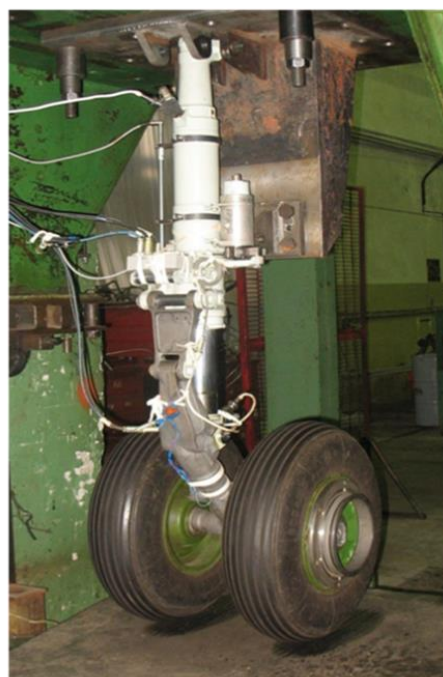
Рисунок 4 – Расчетная схема виртуальных испытаний на сброс опор шасси
